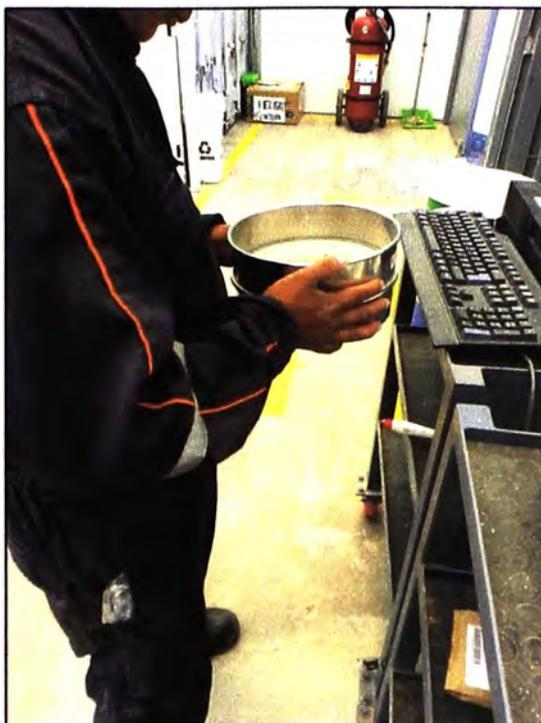
**Figura 8.39.**Prueba de Tamizado, malla 140.
