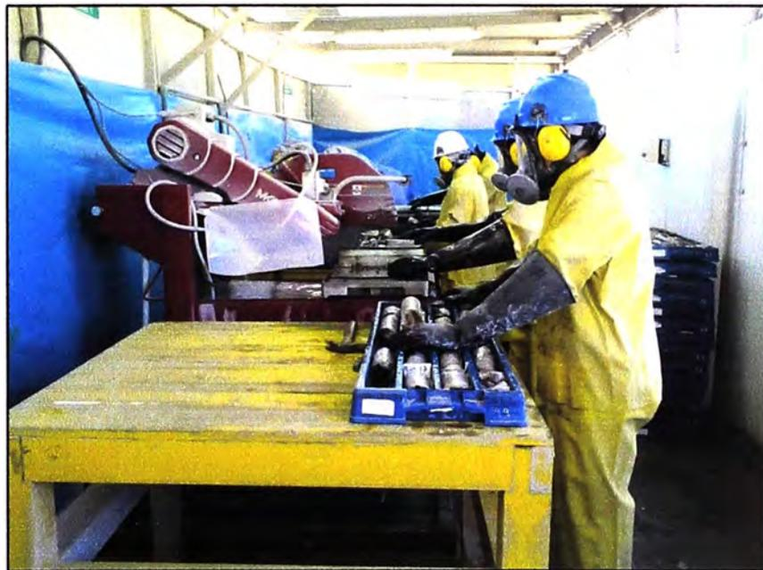
**Figura 8.22** Corte de Sondajes Diamantinos.
