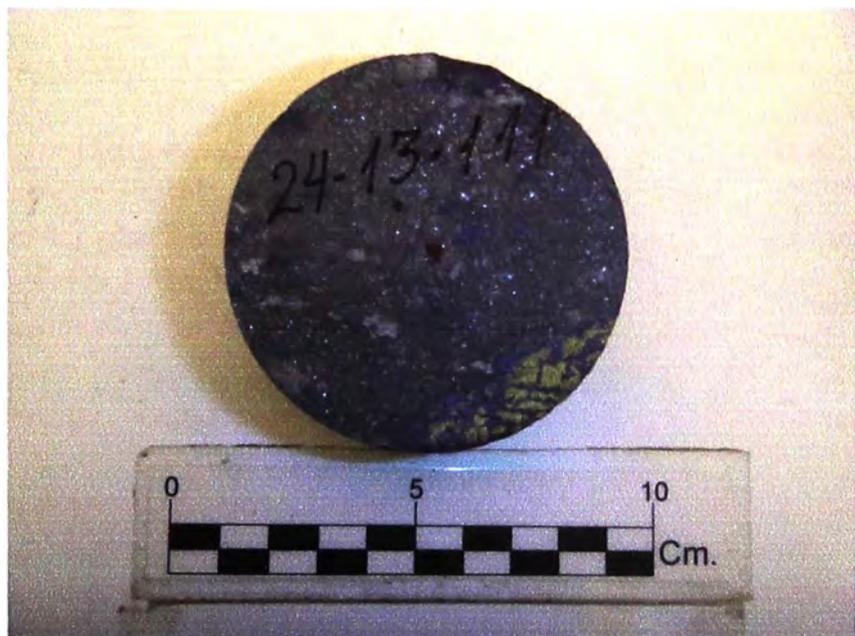
**Figura4.2.** Roca obliterada con reemplazamiento total de alteración magnetita asociada a Bn+Cp.
