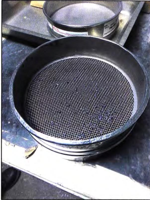
**Figura 8.41.**Control granulométrico de chancado, malla 10.
