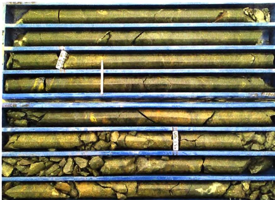
**Figura 4.3.** Andesita de textura porfírica de color verde grisáceo y tonalidad marrón con alteración magnetita en venillas asociada a Cpy +Py en vetas.
