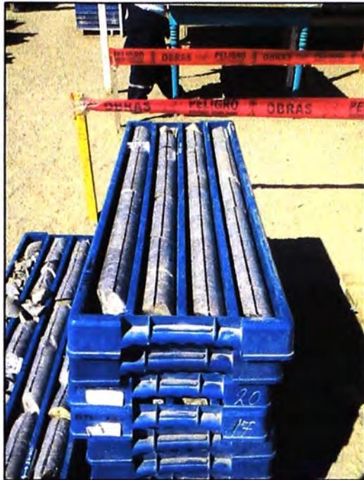
**Figura 8.21** Encintado de los testigos mostrando el eje de corte.
