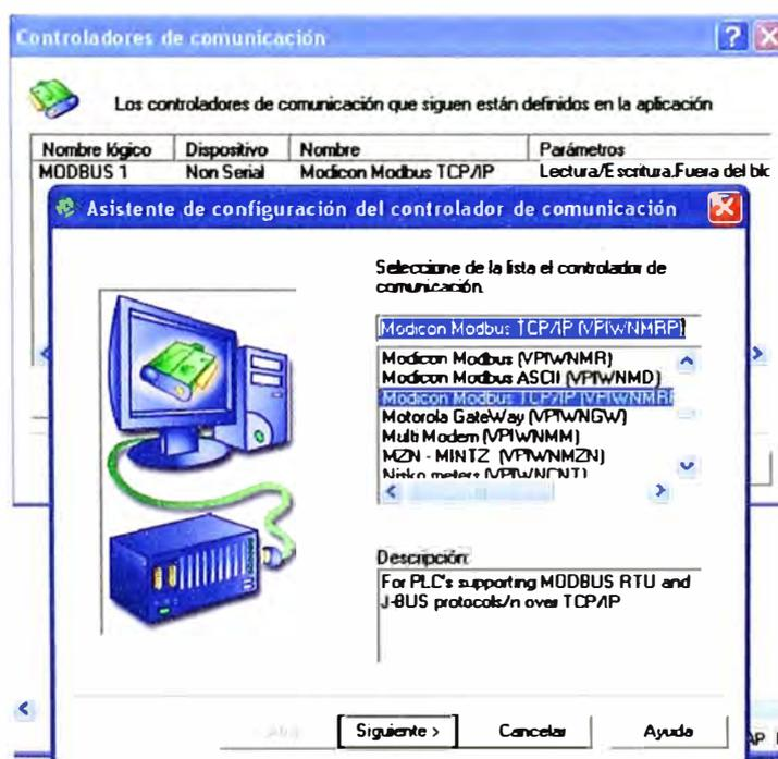
Figura 5.11 Ventana Configuración de Controladores de Comunicación
