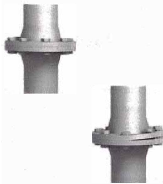
Figura 5. Fugas a presión constante.
