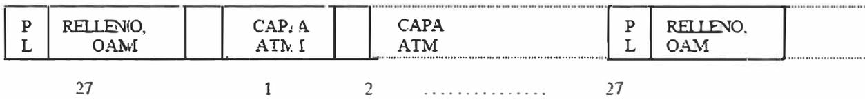
**Figura 1.6: Interfase basada en celdas**
