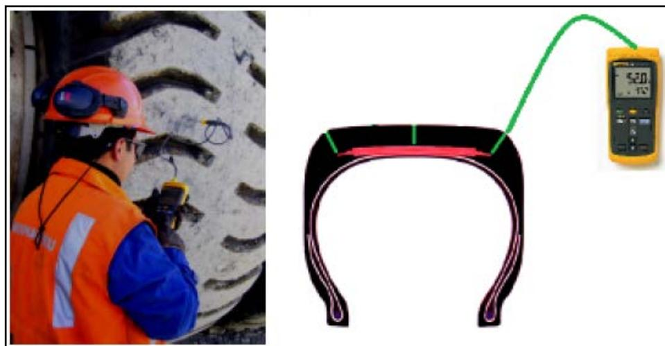
Figura 6.13: Medición externa de Temperatura con Termocuplas [6]
