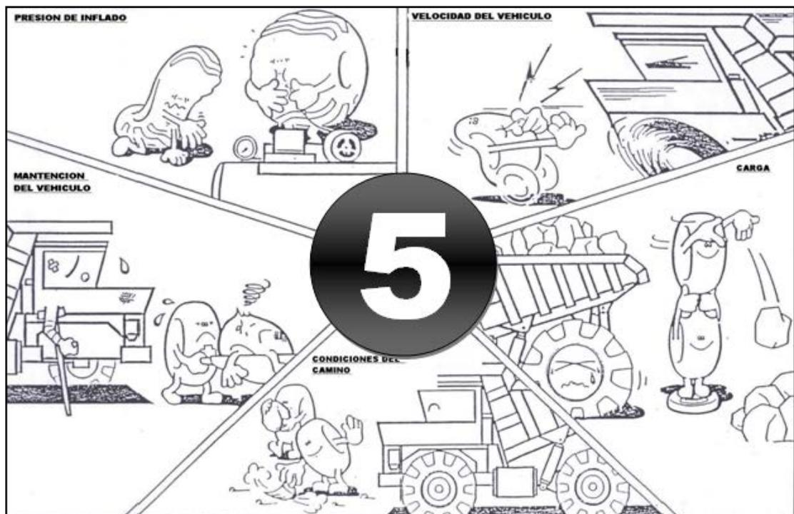
Figura 6.1: Factores que afectan la duración del Neumático [4]
