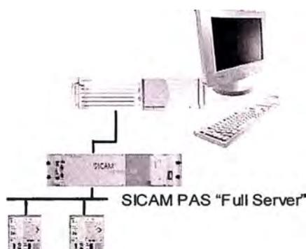
Figura 5.1: Sistema Sicam-Pas a utilizarse en la S.E. Chiclayo Oeste.
