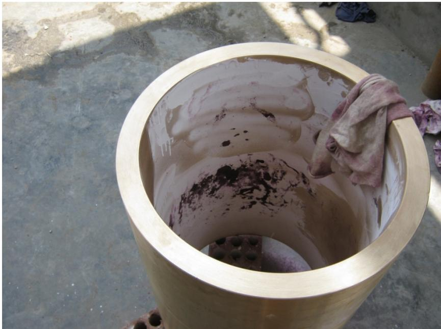
Camiseta fundida en molde de arena por fundición estática obsérvese los defectos de fisuras y porosidad en la parte interior, se ensayo con líquidos penetrantes (Empresa ALTES SAC)
