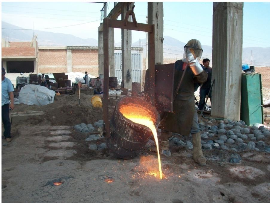
Figura N° 1.1.- Uso de equipo de seguridad apropiado, operario vertiendo el metal al molde (Empresa MEFICO SRL.)
