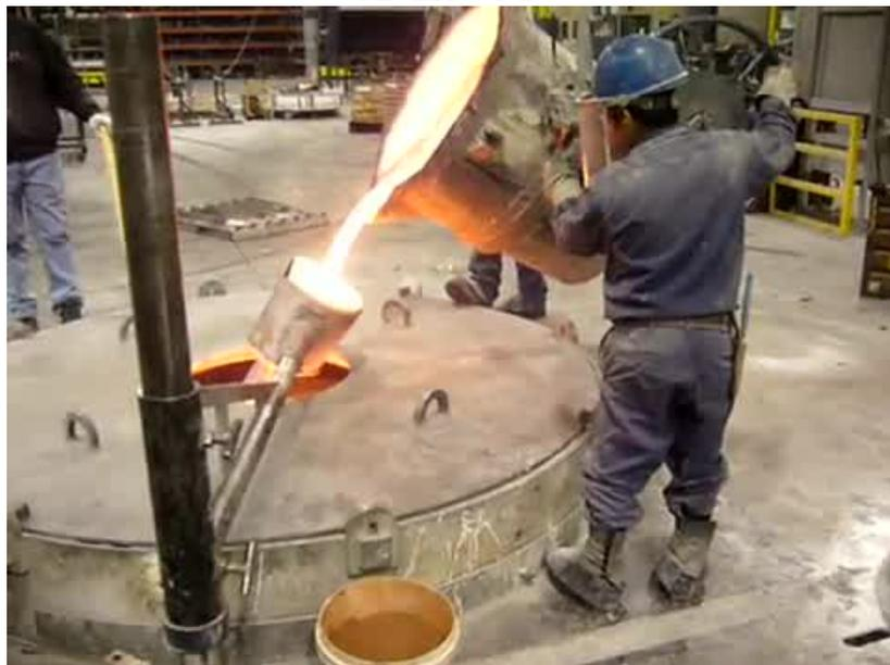
Vertido de metal de la callana en la máquina centrífuga vertical. (Empresa IRIDIUM SA.)
