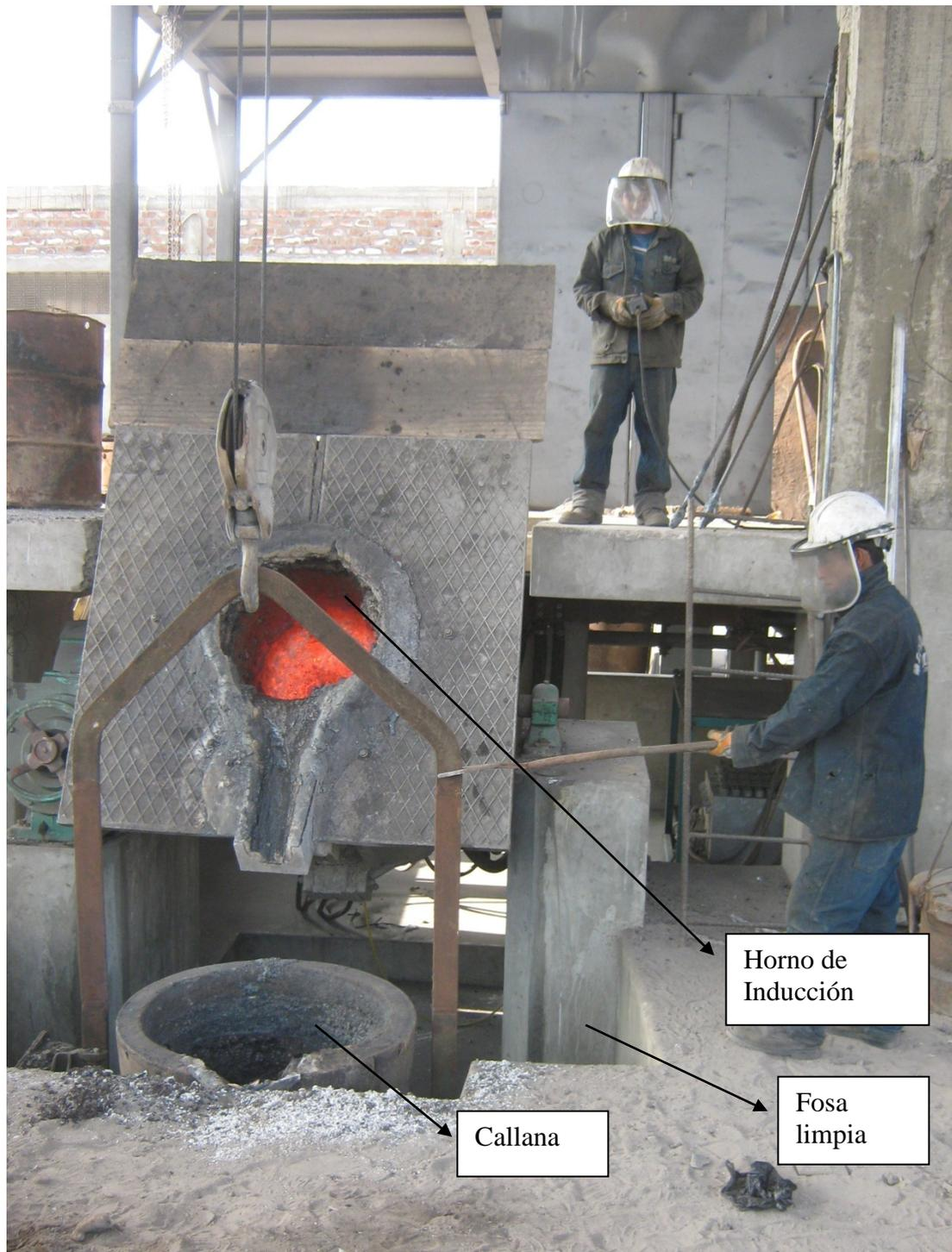
Figura N° 2.8.- Horno de inducción en plena operación. Obsérvese la fosa limpia y la callana en espera de recibir el metal. Referencia (Empres MEFICO SRL)
