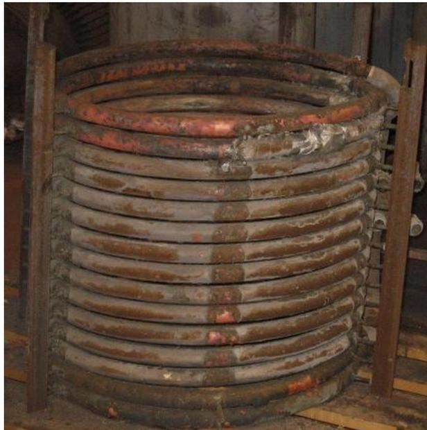
Figura N° 2.5.- Bobina en mantenimiento, espiras sostenidas por soportes aislantes. Referencia (Empresa FUNESPA)
