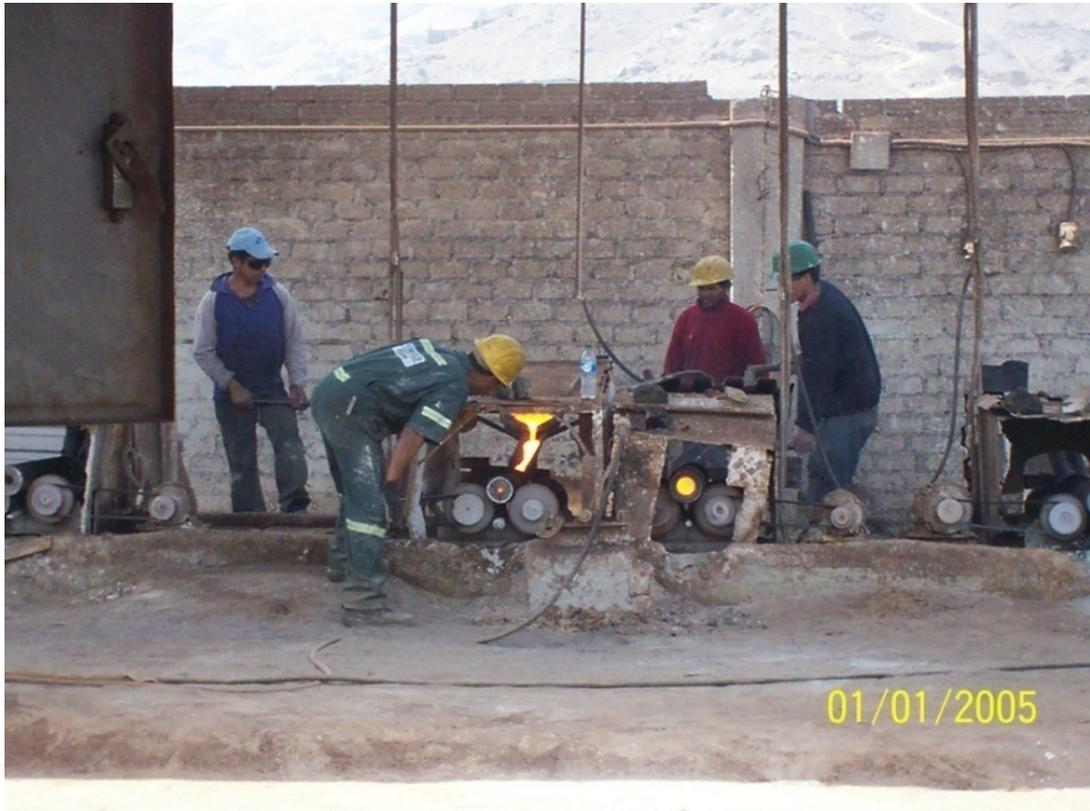
Centrifuga en operación y operarios en el momento de vaciado del metal. (Fundición IRIS)
