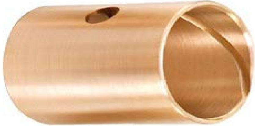
La foto muestra a la camiseta obtenida por el método de centrifugación mecanizada y totalmente acabada, es notorio su buen acabado superficial, libre de fisuras y porosidad (Empresa ALTES SAC).
