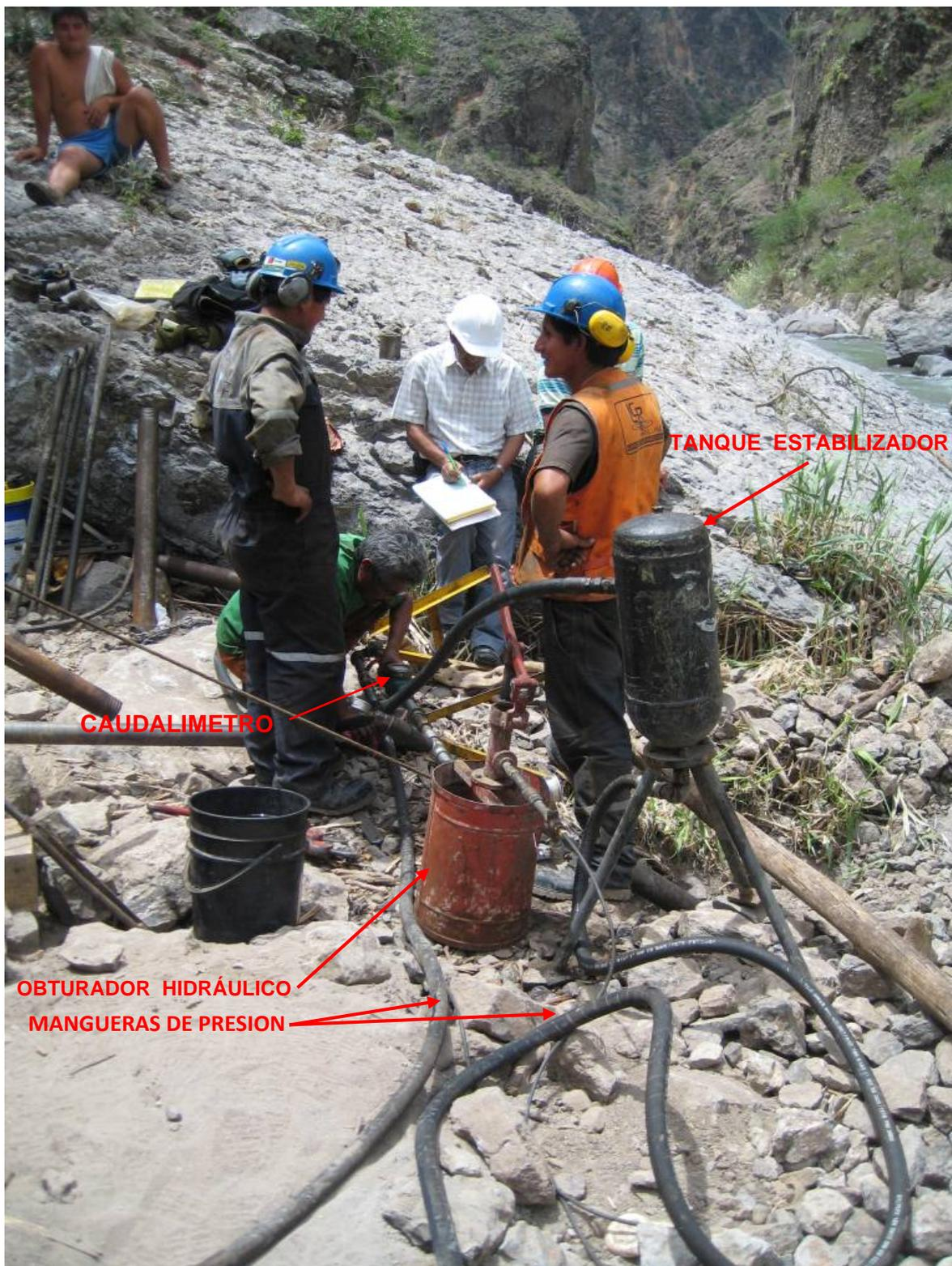
Foto N° 6.1 Realizando La Prueba de Presión de Agua – Tipo Lugeon
