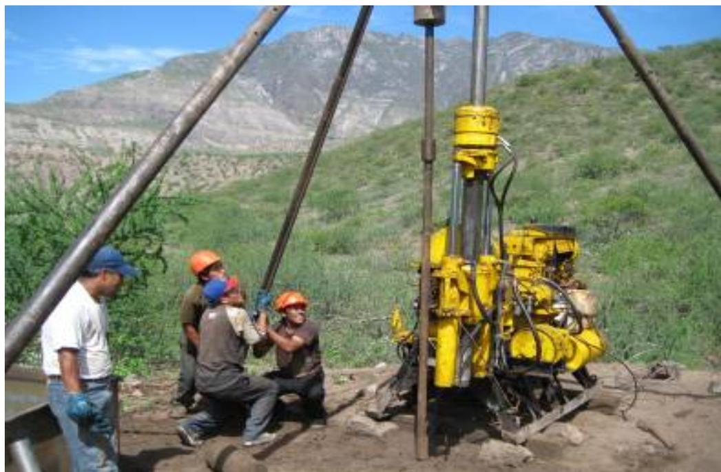
**Foto N° 7.1 Realizando el ensayo de STP**
