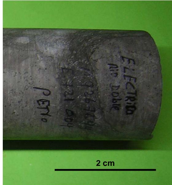
*De acuerdo a lo expuesto podemos referirnos a la muestra como roca carbonatada (Wackestone) con presencia de bioclastos y de aspecto brechoso*
