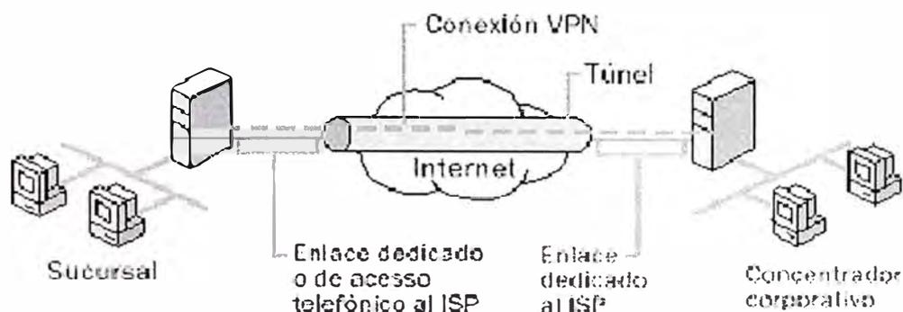
Fig. 1.8 Modelo de Conexión VPN, LAN a LAN.
