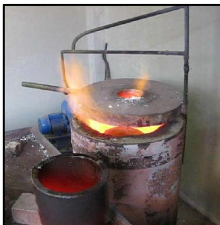
**Figura 5.18:** Horno de fundición de 30 kg de capacidad
