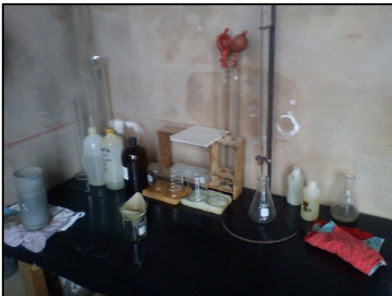
**Figura 4.15:** Instrumentos de titulación para obtener el cianuro libre
