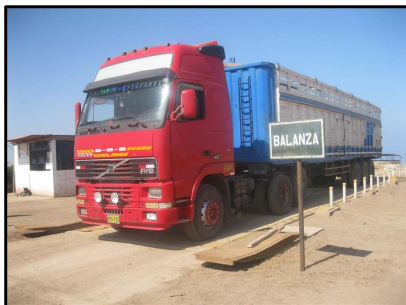
**Figura 1.6:** Balanza digital de 60 toneladas
