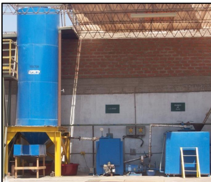
**Figura 5.1:** Entre el reactor, caldero y tanque de paso se forma un circuito cerrado al inicio de la desorción.
