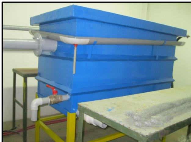
**Figura 5.16:** Celda de electrodeposición
