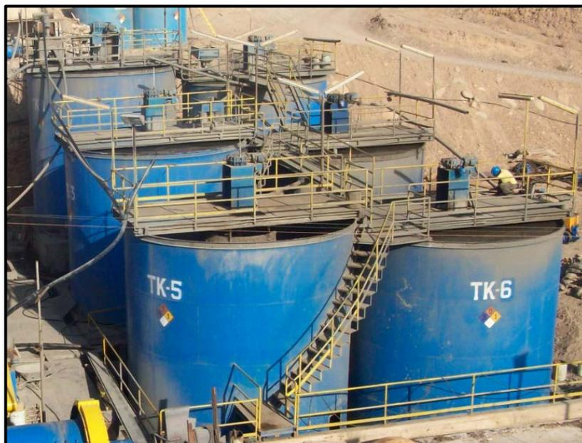
**Figura 4.9:** Tanques de agitación.
