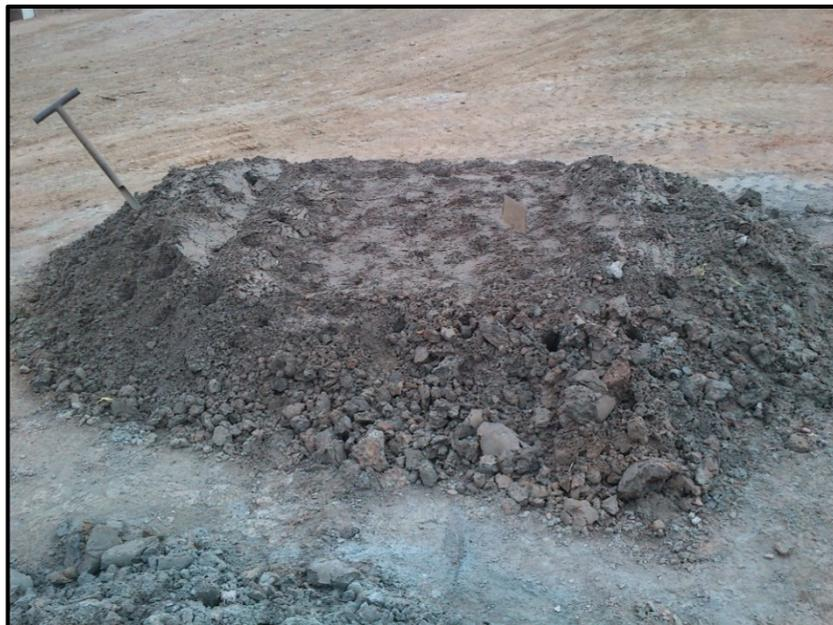
**Figura 2.9:** Muestreo con lanza de un relave
