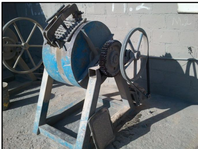
**Figura 3.2:** Molinos de 30 kg de capacidad y de 42 RPM
