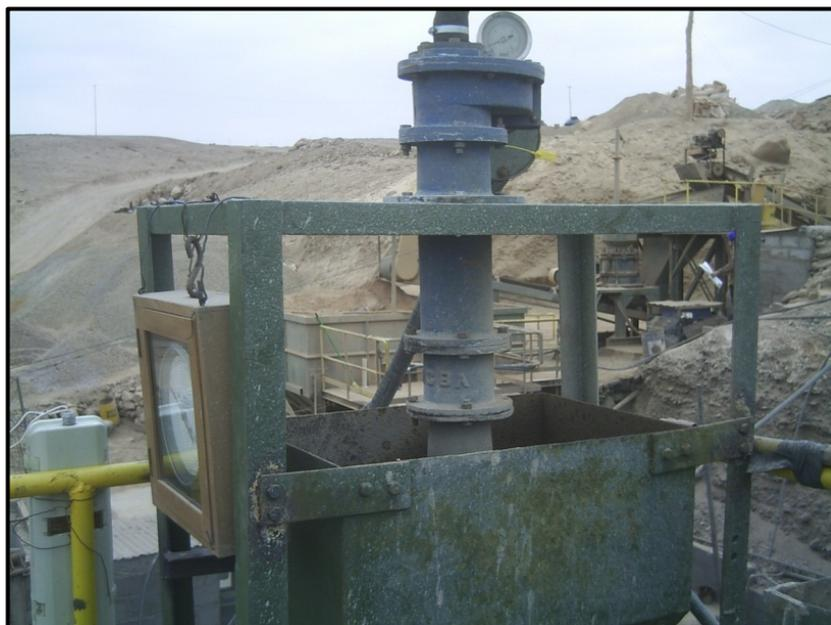
**Figura 4.7:** Hidrociclón ICBA de 6"Ø, sobre el tanque de agitación N° 1
