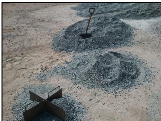
**Figura 2.7:** Muestreo por puntos, por coneo y cuarteo de un mineral
