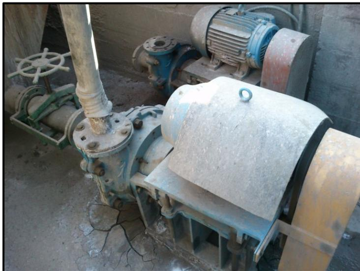
**Figura 4.5:** Bombas de pulpa ESPIASA 5"x4" y 4"x3"
