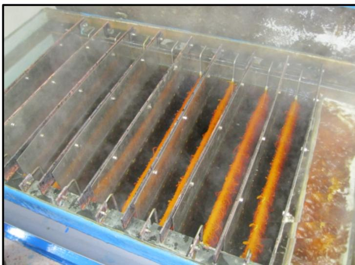
**Figura 5.2:** Inicio de la electrodeposición al hacer ingresar la solución caliente a la celda electrolítica
