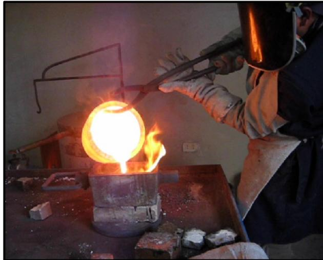
**Figura 5.8:** Colada del material fundido en las lingoteras
