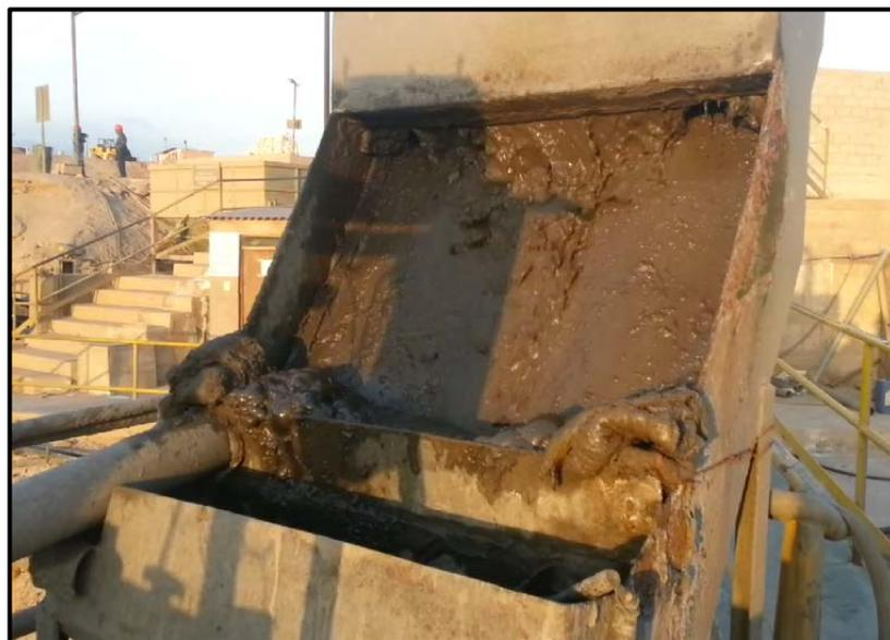
**Figura 4.11:** Cedazo D.S.M. sobre el tanque de agitación N° 1
