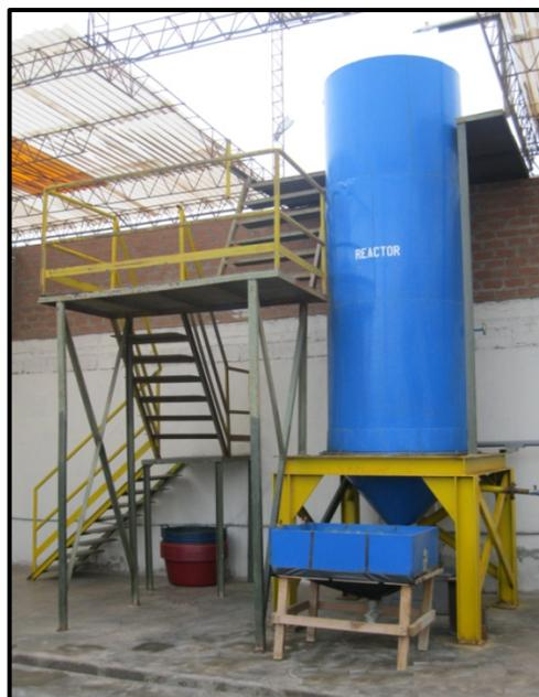
**Figura 5.15:** Reactor de desorción de carbón
