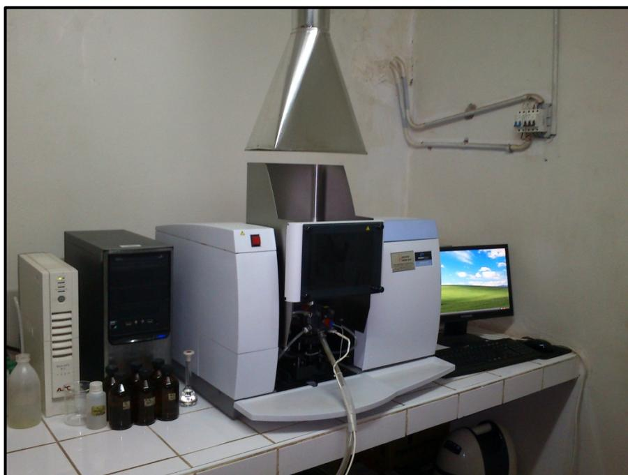
**Figura 7.2:** Equipo de Absorción Atómica Perkin Elmer Analyst 400
