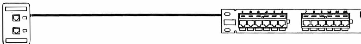
**Fig 4.9** Prueba de enlace entre toma de datos del área de trabajo y el patch panel.
