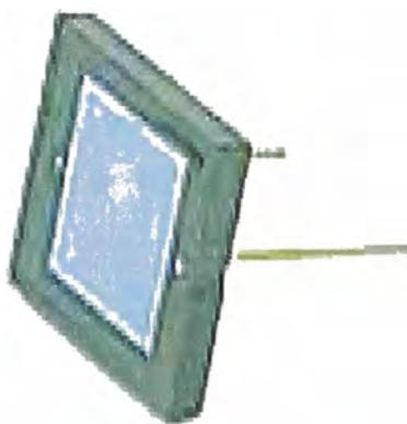
**Fig. 2.3:** Fotodiodo de Silicio.
