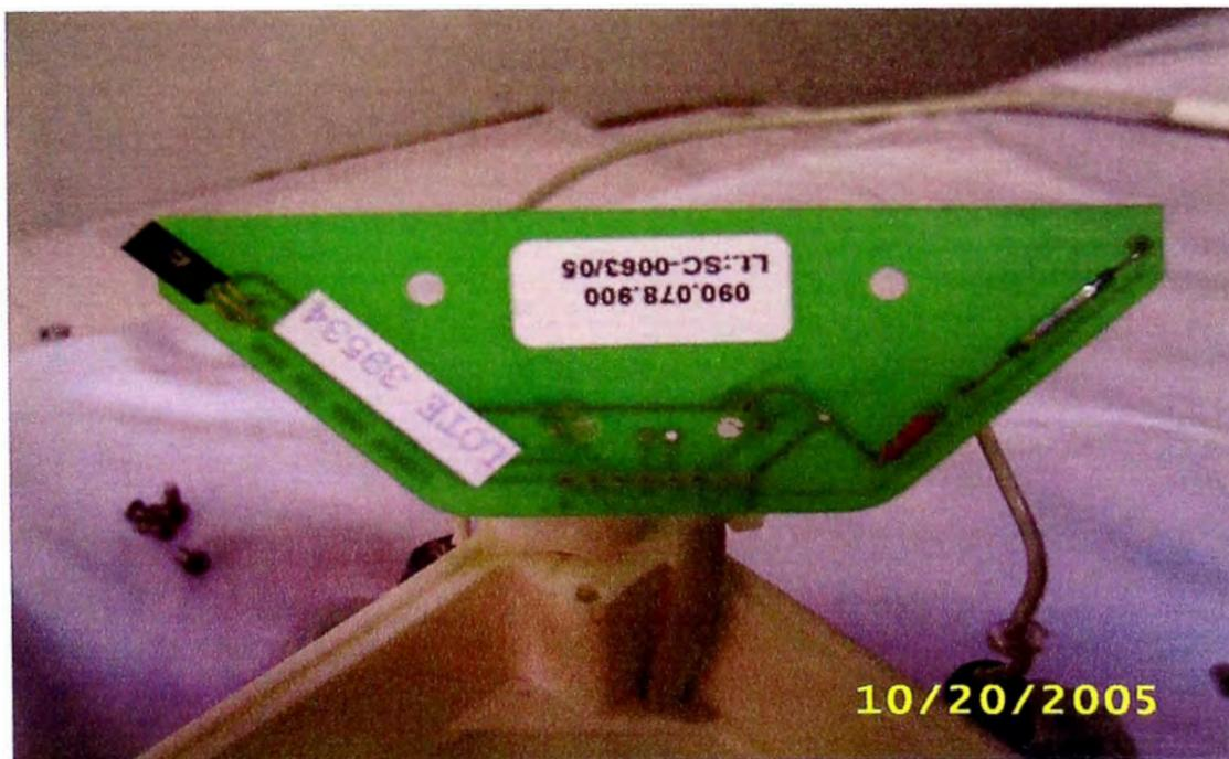
**Fig. C2 – Sistema del Sensor de Humedad en la Incubadora**
