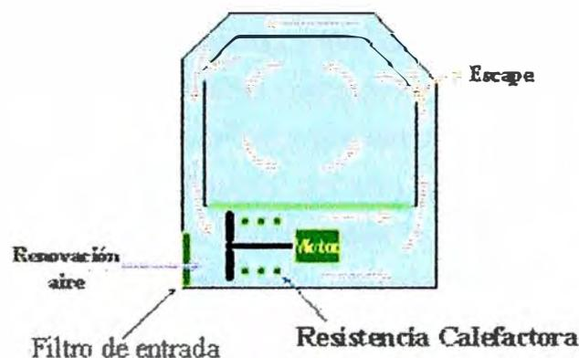
**Fig.1.2 - Entrada de Aire en la incubadora**
