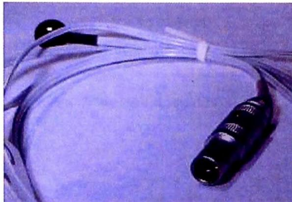
Fig. B2 – Sensor de Temperatura para Piel
