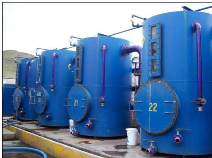
**Figura N° 2.5** Circuito de Adsorción N°4
