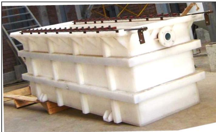
**Figura N°2.8** Celda electrolítica ABB con 17 cátodos y 18 ánodos
