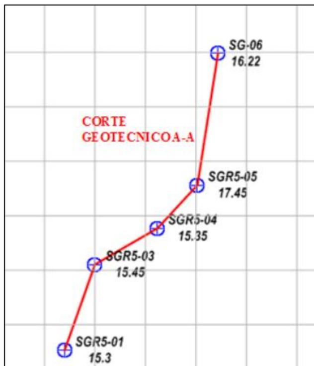
Figura N°1.7: Ubicación y profundidad de sondeo (Fuente: Proyecto Muelle Norte).
