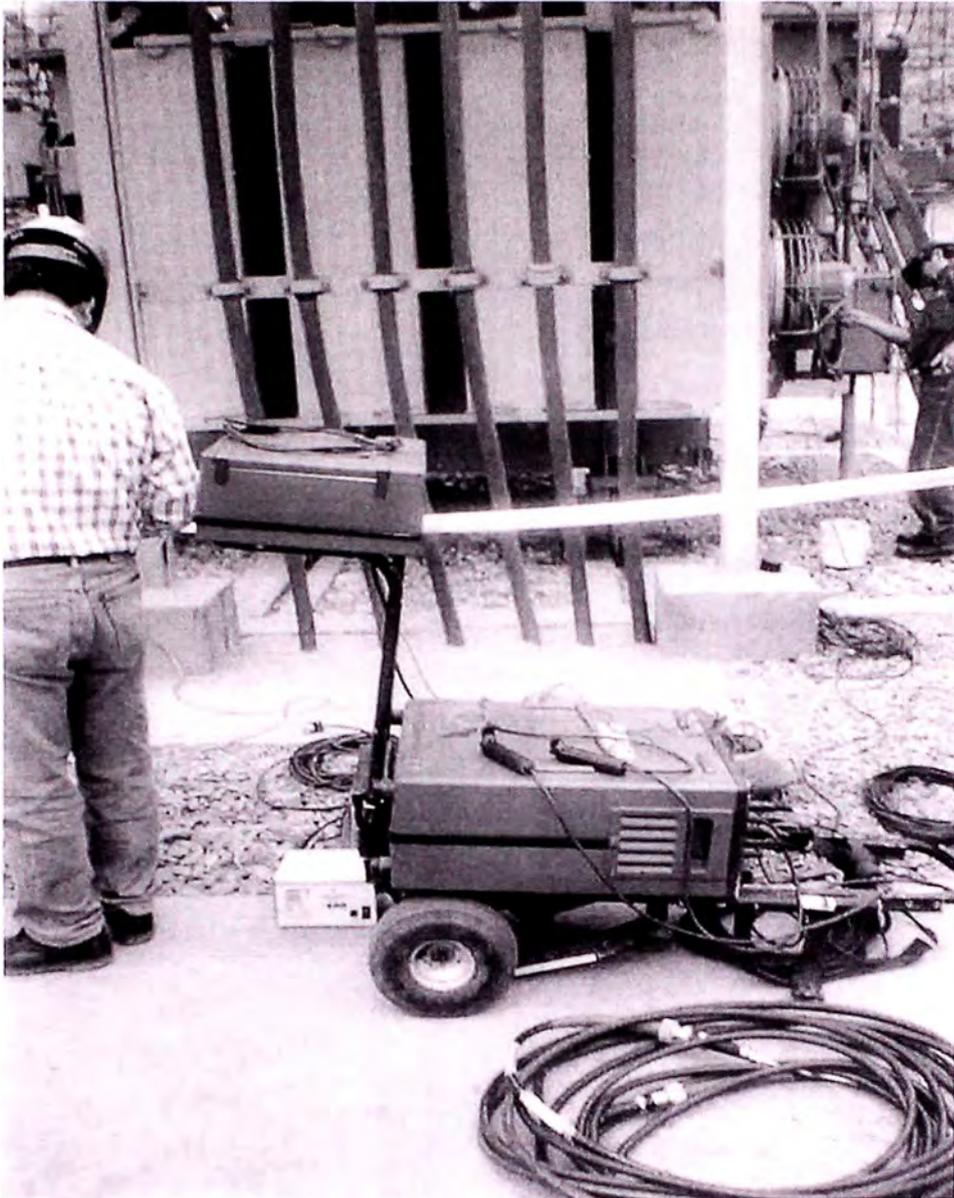
**Foto A1:** Equipo portátil computarizado para realizar Pruebas Eléctricas DOBLE M – 4000
