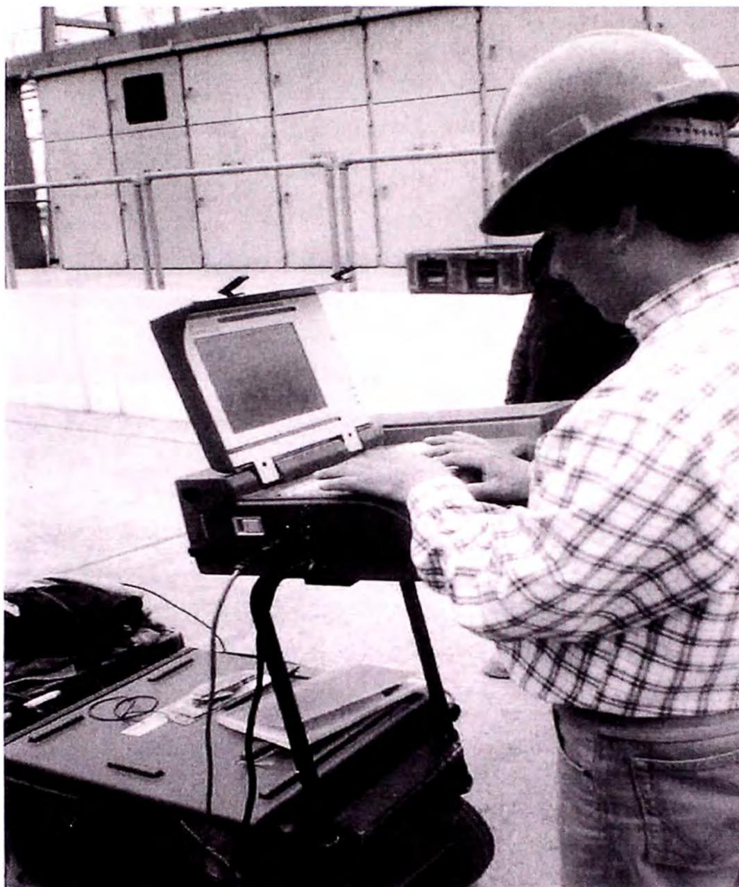
**Foto A5:** Aplicación de la Prueba Corriente de Excitación.
