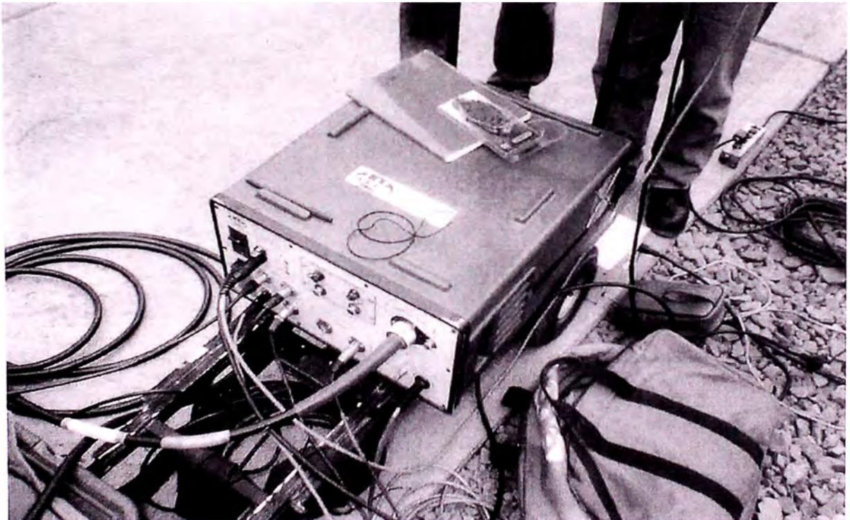
**Foto A3:** El Analizador Automático de Aislamiento.
