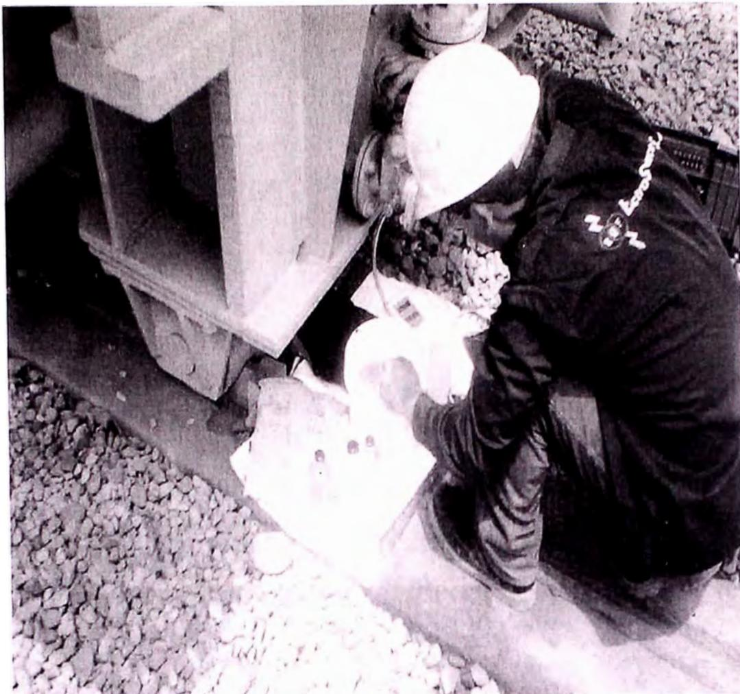
**Foto C12:** Muestra de aceite para verificar la humedad, Físico-Químico.
