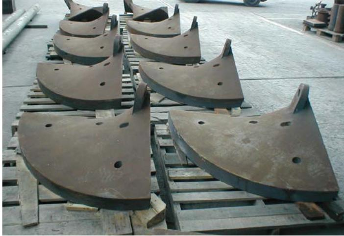
Fig. 14 Forro de molino vertical
