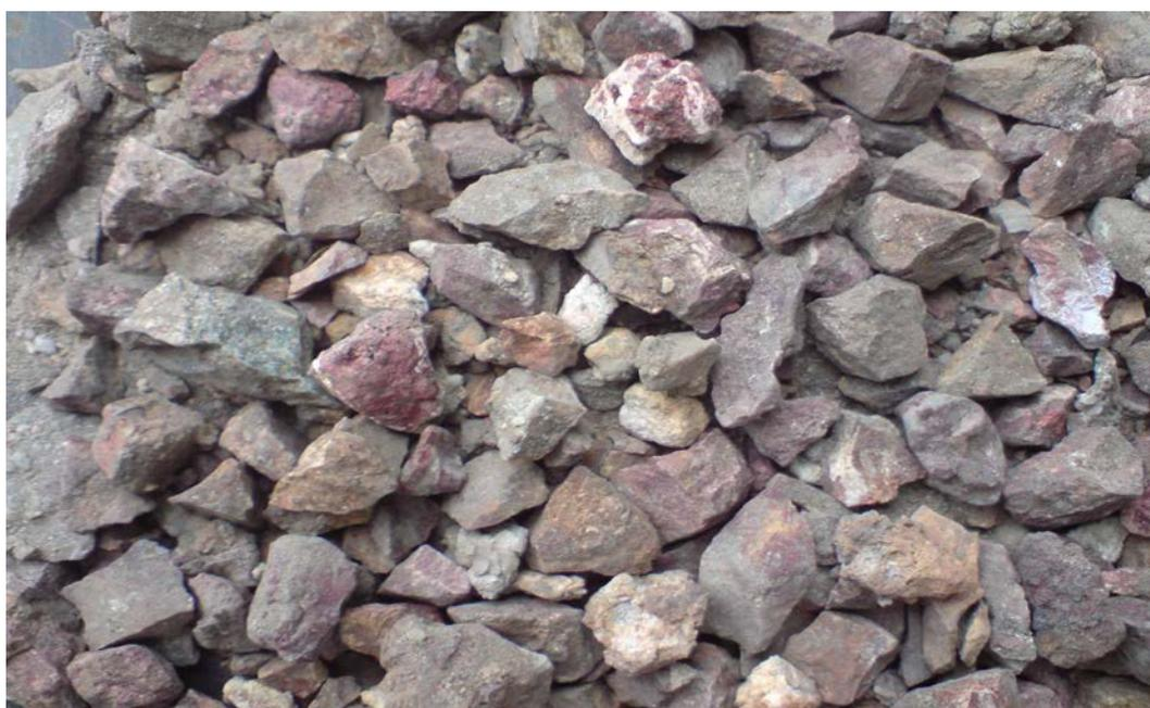
Foto N° 12 Ripio de la lixiviación de cobre con ácido sulfúrico (sin lavar).
