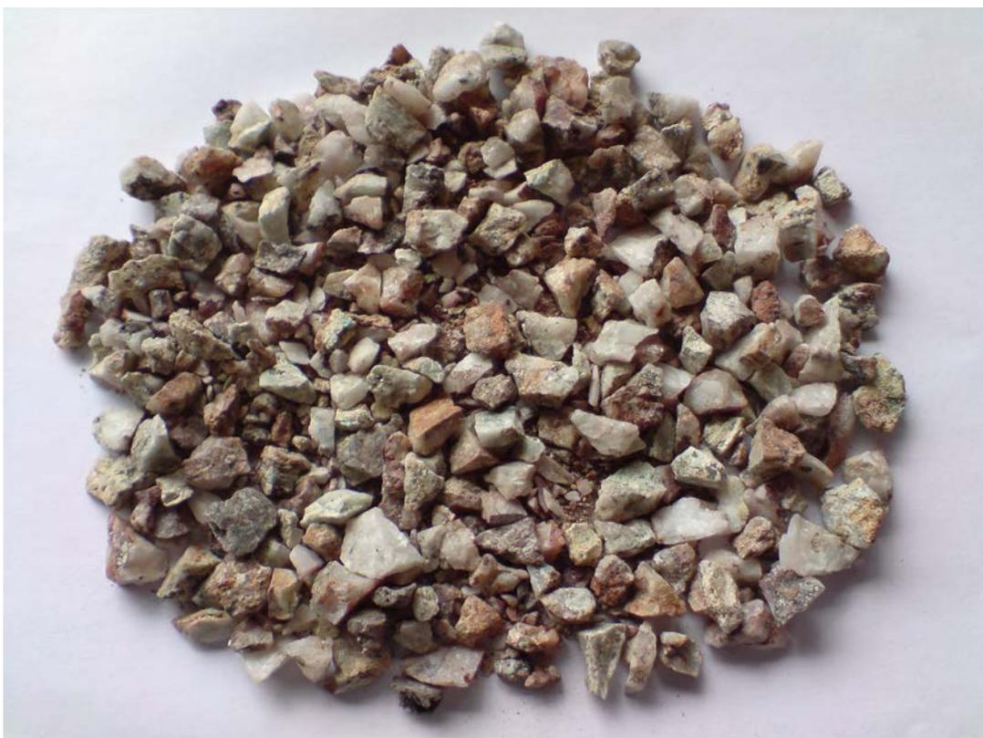
Foto N° 10 Ripio de la lixiviación de cobre con ácido sulfúrico (lavado).
