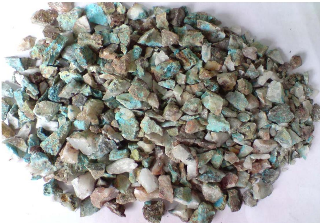
Foto N° 9 Minerales de oro con cobre antes de lixiviar con acido sulfúrico.
