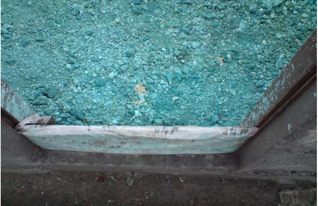
Foto N° 13 Cobre recuperado de las pruebas piloto.
