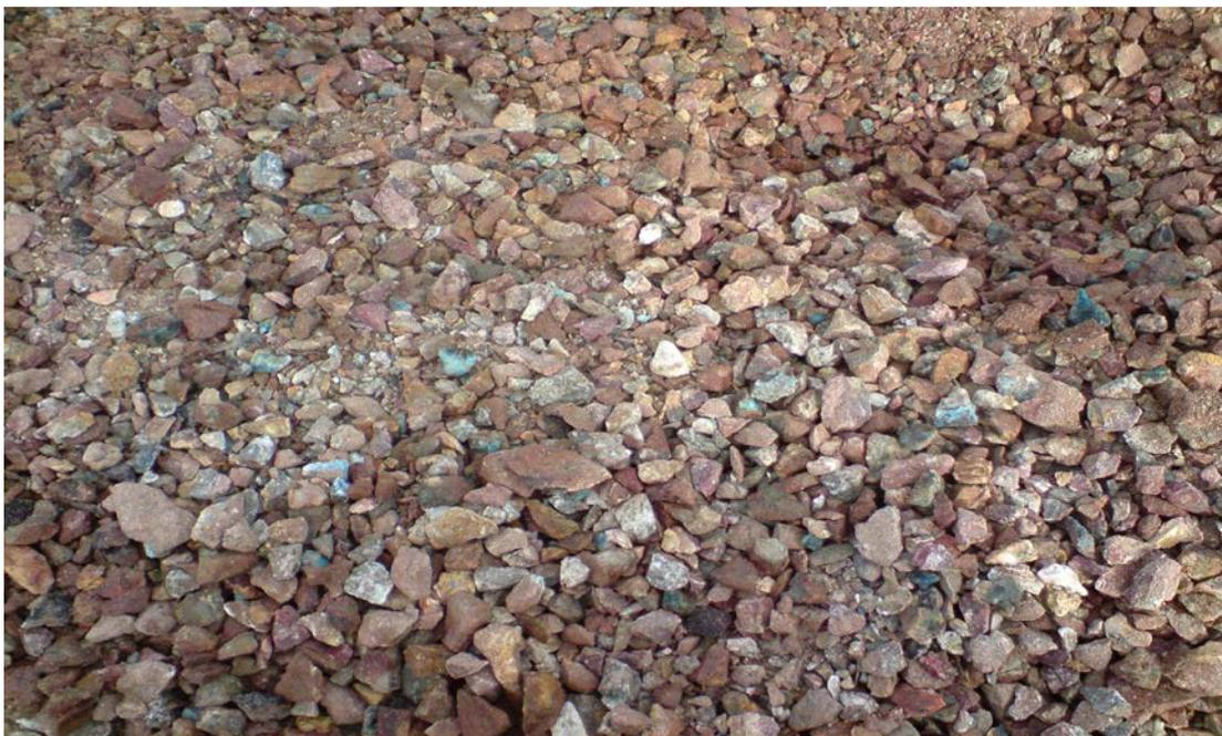
Foto N° 11 Minerales de oro con contenidos de cobre antes de lixiviar cobre.
