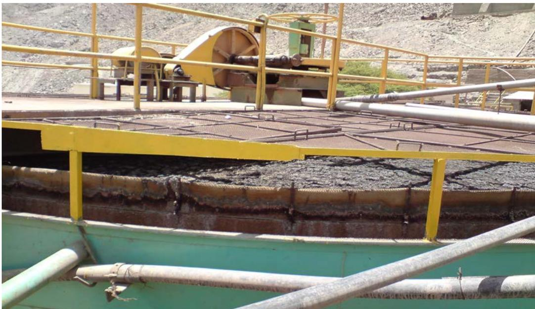
Foto N° 6 Espumas formadas en el espesador 30' x 10'.
