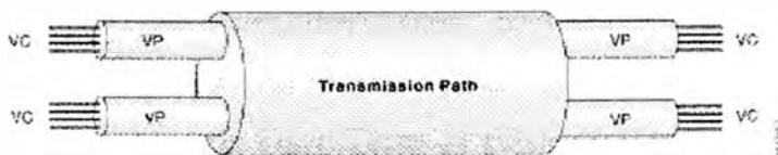
Fig 1.3.1 Concatenación de circuitos virtuales VC para convertise en VP
