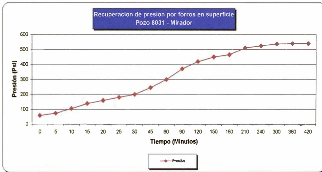
Notas : La presión se estabilizó a las 8 horas de prueba llegando hasta una presión de 570 psi.
