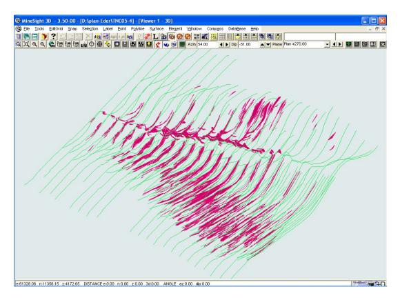
Por la inclusión de equipo de mayores dimensiones en la operación se hace necesario cambiar la altura de bancos de 8 m a doble bancos de 6m, llegando a ser 12m de altura, de igual modo se tuvo que cambiar el alto de los blocks tanto de Corto y Largo Plazo de 8 a 6m.
