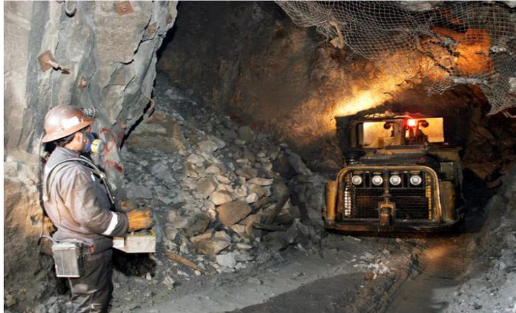
FOTO 3: LIMPIEZA DE MINERAL DE LOS SUBLEVEL STOPING CON TELEMANDO
