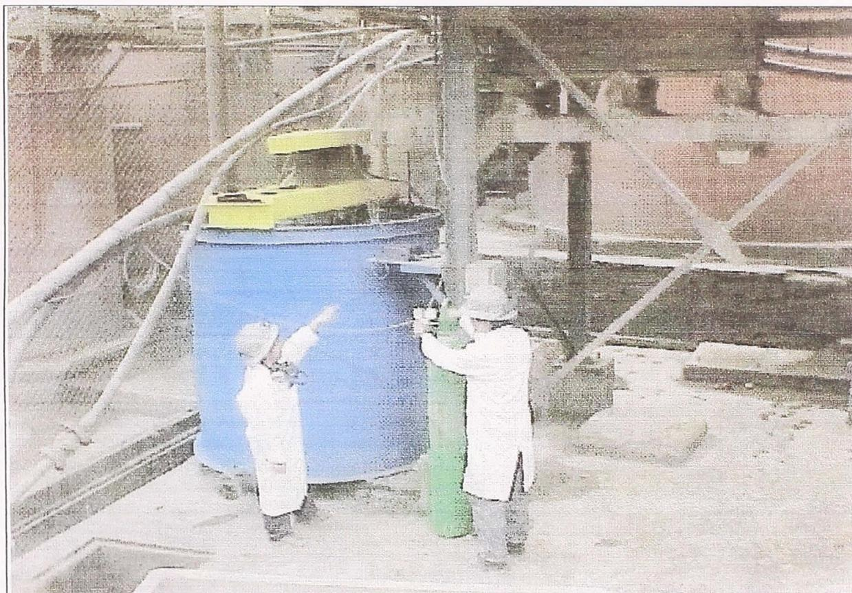
**Foto N° 1 : Prueba de Cianuracion inyectando Oxigeno.**
