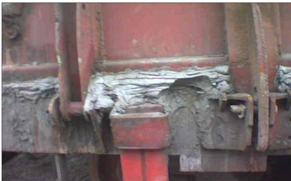
**ig. N° 2 Contaminación del suelo y aire del concentrado, por el mal sellado de las compuertas.**
