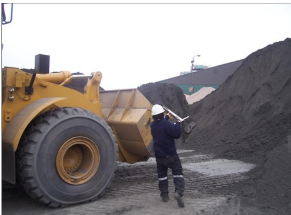
**Fig N° 18. Toma de muestra al levante del concentrado por el pay loaders.**
