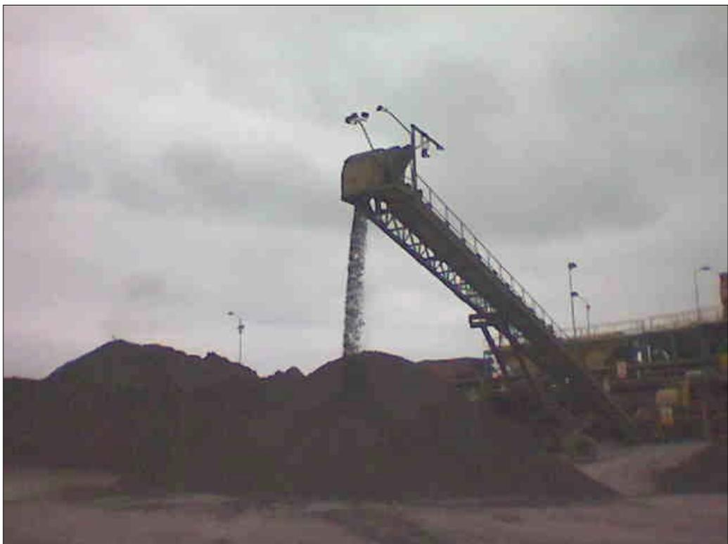
**Fig. N° 27. Ruma en proceso de almacenamiento de concentrado de Zn**
