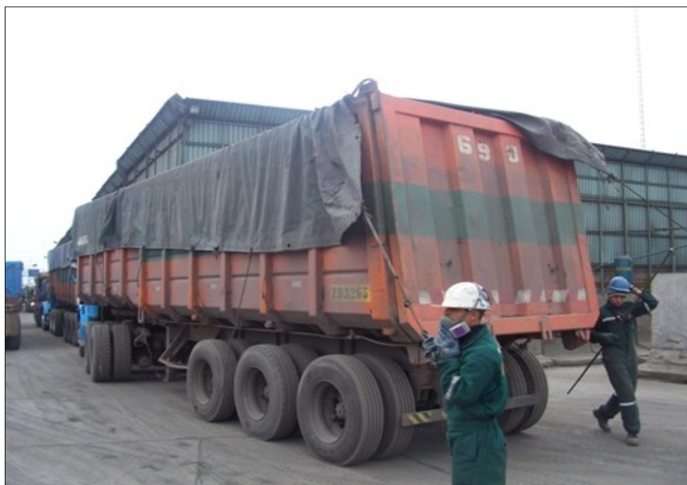
**Fig N° 17. Cubierta de la tolva a la unidad de transporte.**
