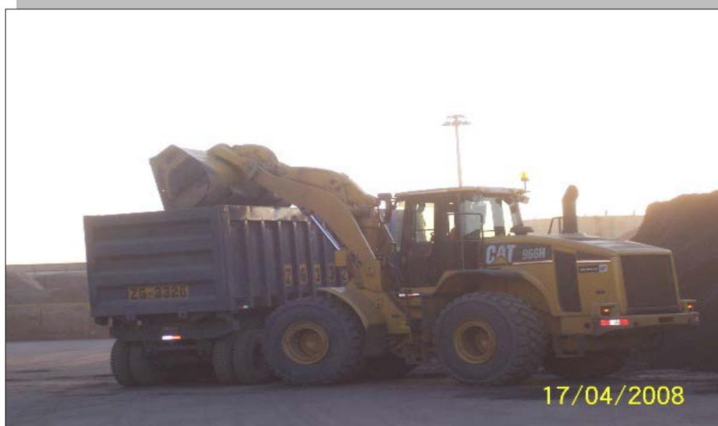
**Fig N° 28. Carguio de concentrado a la unidad de transporte.**
