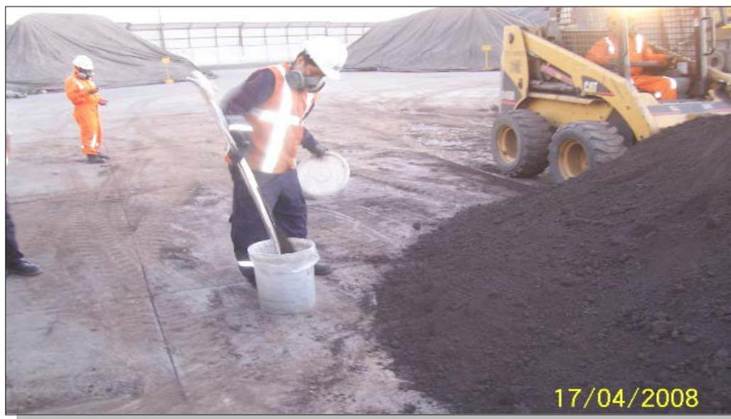
Fig N° 30A. Muestreo a la ruma descargada.
