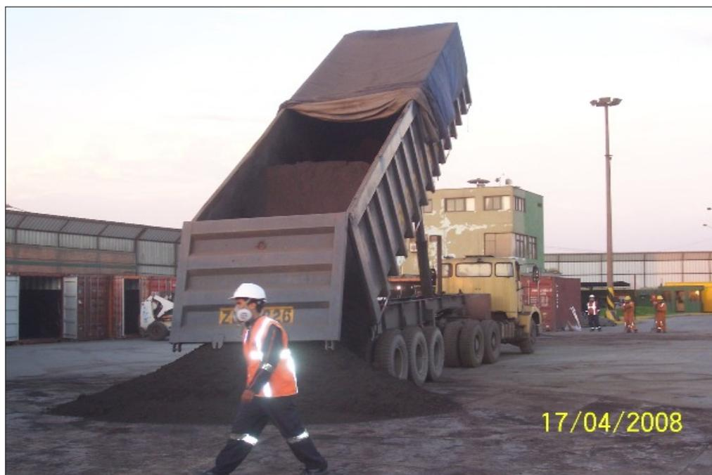
**Fig 29. Unidad procediendo a la descarga del concentrado.**
