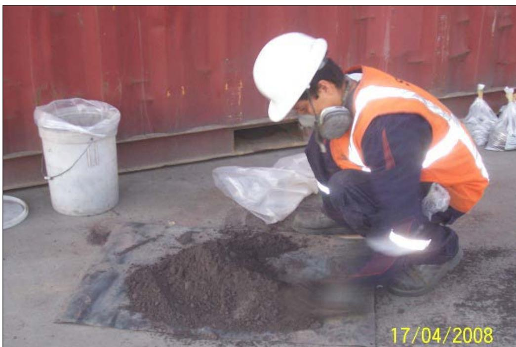
Fig N° 30B. Reducción a la muestra.
