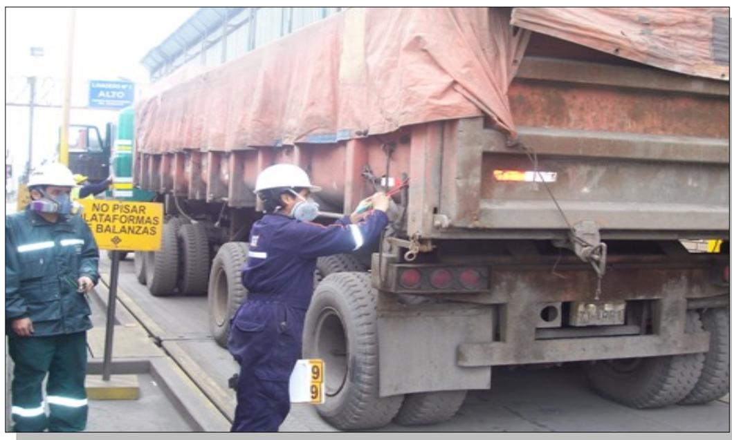
**Fig N° 19. Unidad en balanza y Puesta del precinto por parte del supervisor en el sujetador de la compuerta.**
