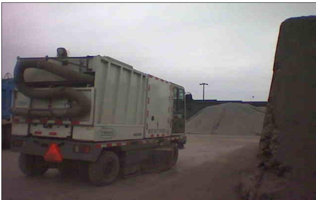
**Fig. Nº 9. Maquina barredora limpiando área descargada.**
