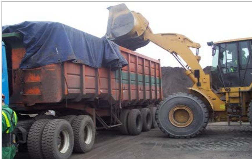
**Fig N° 16. Carguio del concentrado a la unidad de transporte.**
