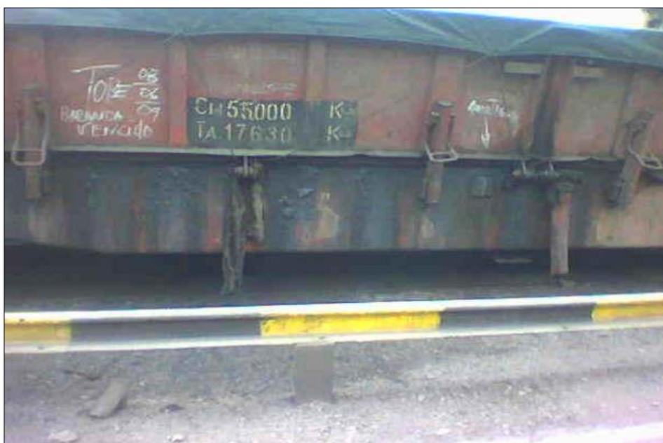
Fig Nº 1B. Vagones en condiciones no aptas para el transporte de concentrado.
