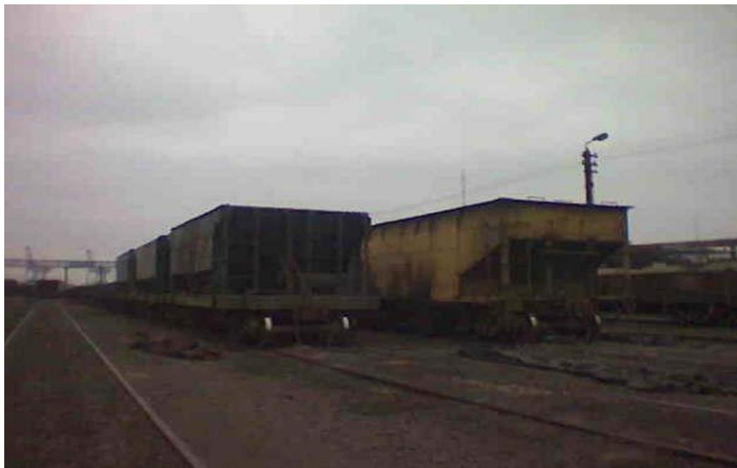
**Fig N° 23B. Hopper sin sus cubiertas o tolderas.**
