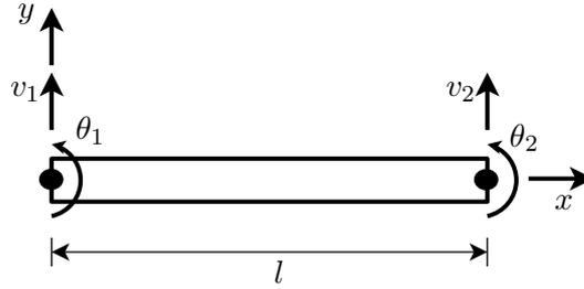
Figura 2.2: Elemento finito de una viga
