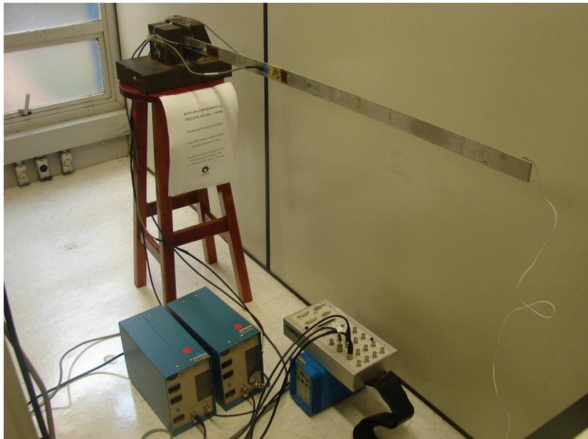
Figura C.1: Viga experimental empotrada-libre implementada en el Laboratorio de Mecánica Computacional, en la Facultad de Ingeniería Mecánica de la UNICAMP.
