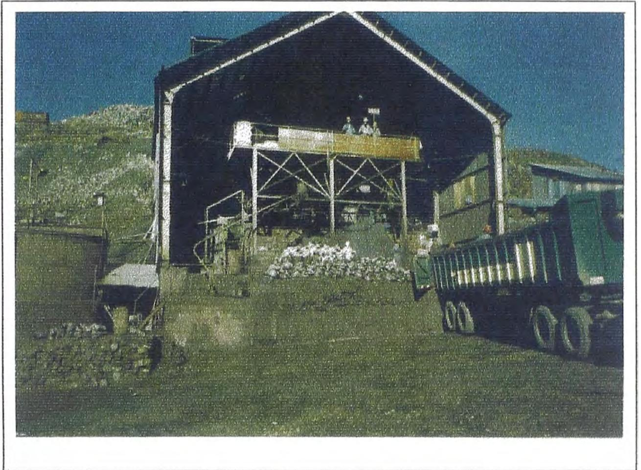
Foto N° 5. Al fondo se observa el sistema de filtrado para el concentrado de Zn, a la izquierda su espesador respectivo y finalmente el transporte de concentrado.
