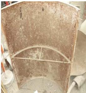
Accesorio de fierro y latón hechizo generalmente para darle forma a los buzones de 1.20 y 1.50 de diámetro u otro diámetro, allí se realiza el encofrado para los buzones.
