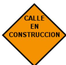
SEÑAL CALLE EN CONSTRUCCIÓN. Deberá utilizarse para prevenir al Conductor de las labores que están realizándose, de construcción o mantenimiento y que inciden en la operación de la vía.
