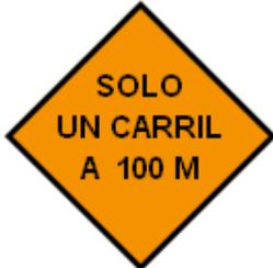
SEÑAL «SOLO 1 CARRIL DE CIRCULACIÓN». Se utilizará para prevenir al Conductor que circula por una calzada o carretera de dos carriles de circulación, que posteriormente se ha clausurado uno de ellos. Esta señal deberá colocarse a una distancia no menor de 100 Mts. del inicio de la restricción.
