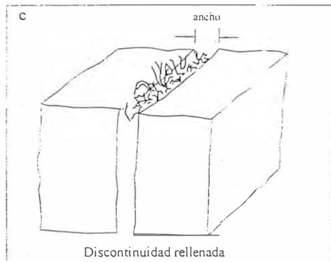
Figura 4: Diagramas que muestran la definición de la apertura de las discontinuidades y el ancho de las discontinuidades rellenas.
