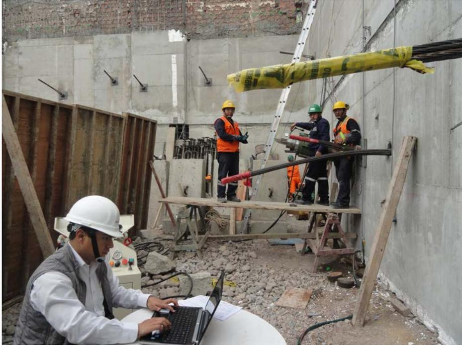
**Fotografía 11.** Ejecución del ensayo de arrancamiento consistente en la aplicación de ciclos de carga y descarga, medición de deformaciones del anclaje postensado y muro de concreto armado, y monitoreo del ensayo en tiempo real usando un ordenador. Ensayo de arrancamiento del anclaje PL-07P, previsto para la obra muros anclados del Edificio Centro Empresarial Platino III, Miraflores - Lima. Cortesía Geotécnica S.A.C.
