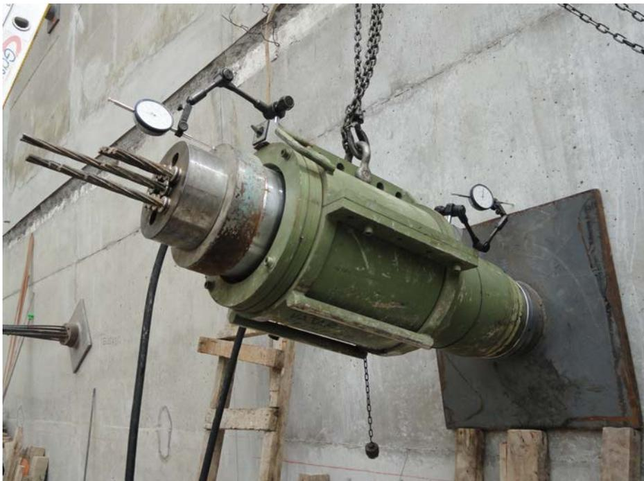
**Fotografía 10.** Sistema de tensado instalado completamente para iniciar el ensayo de arrancamiento. Se aprecia el pistón hidráulico Mekano4, cabezal superior sujetado con clavetes, cabezal inferior y placa de apoyo contra el muro estructural, dos micrómetros para medir deformaciones en anclaje y muro. Ensayo de arrancamiento del anclaje PL-07P, previsto para la obra del Edificio Centro Empresarial Platino III, Miraflores - Lima. Cortesía Geotécnica S.A.C.
