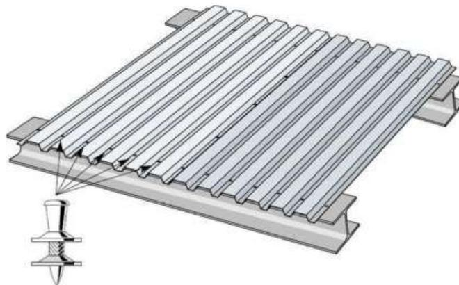
Figura N° 2.11 Grampa usada para la unión de sistema deck.
