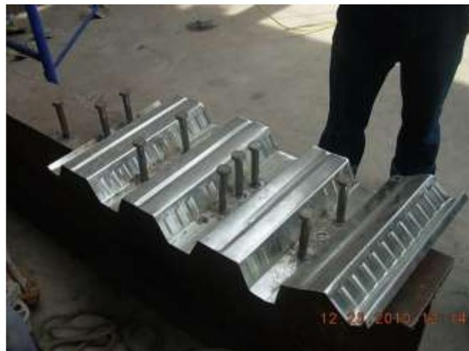
Figura N° 2.5 Prueba de colocación de conectores de corte soldados al ala superior de un perfil "I" (Obra almacén XIMESA).
