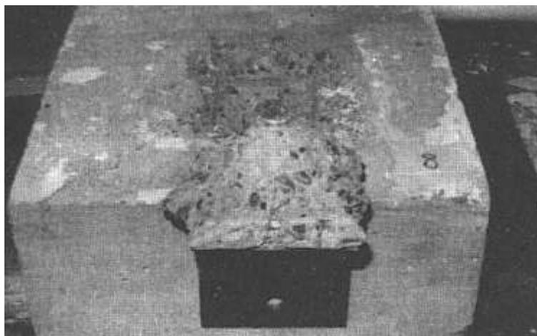
Figura N° 6.11 Fallas por corte en los conectores.
