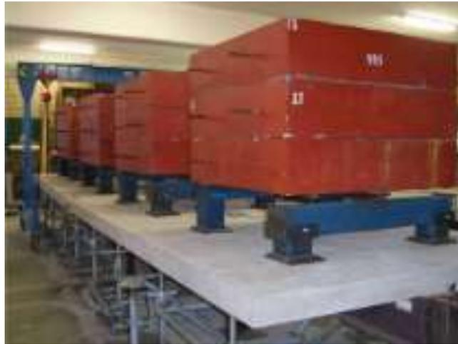
Figura N° 4.5 Bloques de concreto que simulan cargas constantes.
