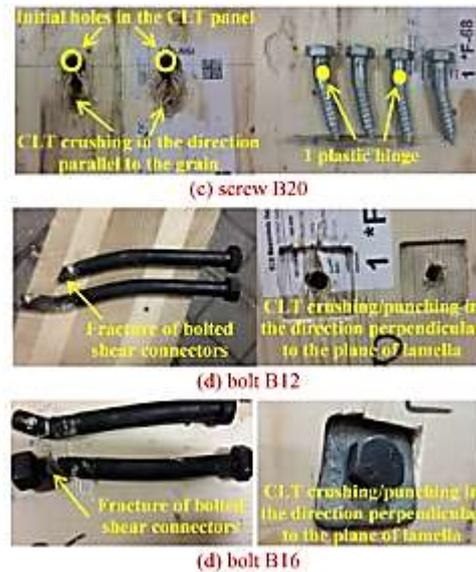
Figura N° 4.11 Fallas ocasionadas en los conectores de corte ensayados.
