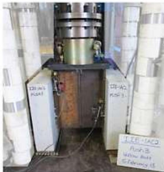
Figura N° 6.22 Ensayo "push out" para carga de corta duración.
