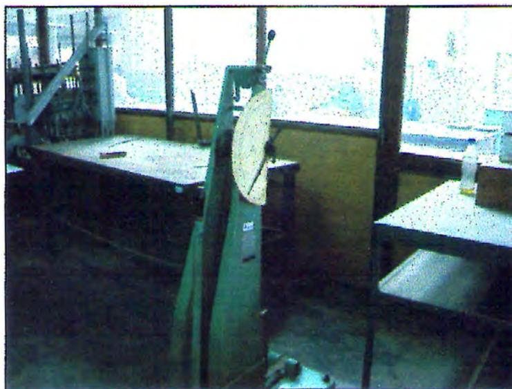
**Figura N° 4.9** Maquina de ensayo de impacto de 30 Kg-m (294 J).
