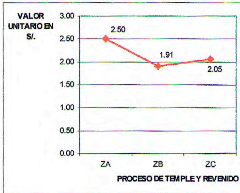
Figura N° 5.5 Costos en función del proceso de temple y revenido.
