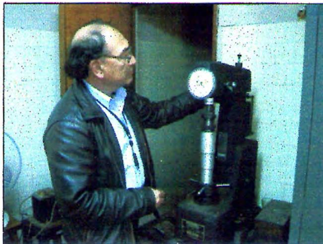
Figura N° 3.3 Maquina de ensayo de dureza Rockwell C.
