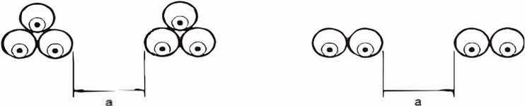
Nota: Los valores dados se aplican a una instalación con 0,7 m de profundidad y una resistividad térmica del suelo de 2,5 K.m/W. Son valores promedio para el rango de dimensiones de cables y tipos acotados para la Tabla 2. El proceso de promediar con redondeo, puede resultar en algunos casos en errores de hasta  $\pm 10\%$ . (Cuando se requiere valores más precisos estos pueden ser calculados por los métodos dados en la Norma IEC 60287).
