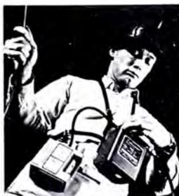
MSA de detección de gas, para lapsos de muestreo de hasta ocho horas. Los instrumentos probadores se pueden situar a distancias de hasta 100 pies del sitio que se ha de analizar cuando se usan tubos de muestreo de ¼ pg. D.I.
