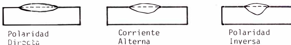
Fig. 2.11. Profundidad relativa de la penetración para diferentes características de corriente.
