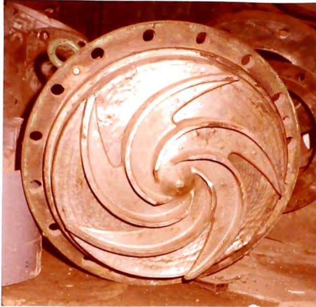
FU CIÓN DE LA PIEZA.- Mantiene fijo el eje y cierra herméticamente la caja d la bomba, el impulsor gira en forma paralela a esta placa.
