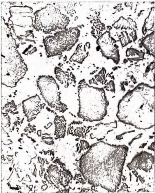
Fig. 8.14 Depósito de carburos de tungsteno con menor espaciado entre los carburos y mayor dureza en la matriz Tungtec 10112 Eutectic + Castolin
