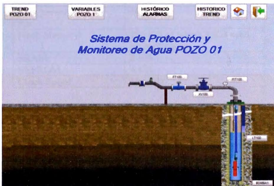
Con esta parte del programa se puede ayudar al operado, con el monitoreo constante del caudal, temperatura del motor, la variación del nivel freático y señales del variador de velocidad.
