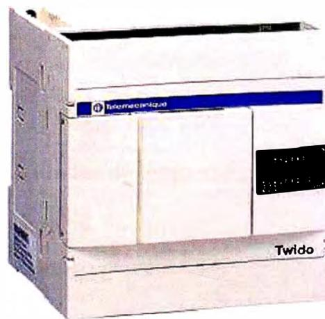
**Figura 4.2.** Controlador Lógico Programable (PLC)
