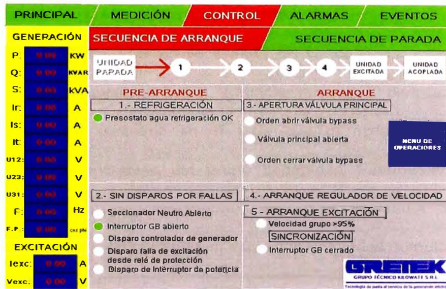
Figura 4.26. Pantalla de secuencia de arranque del grupo generador.
