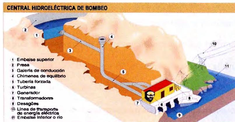
**Figura 2.6.** Central hidroeléctrica de acumulación por bombeo.
