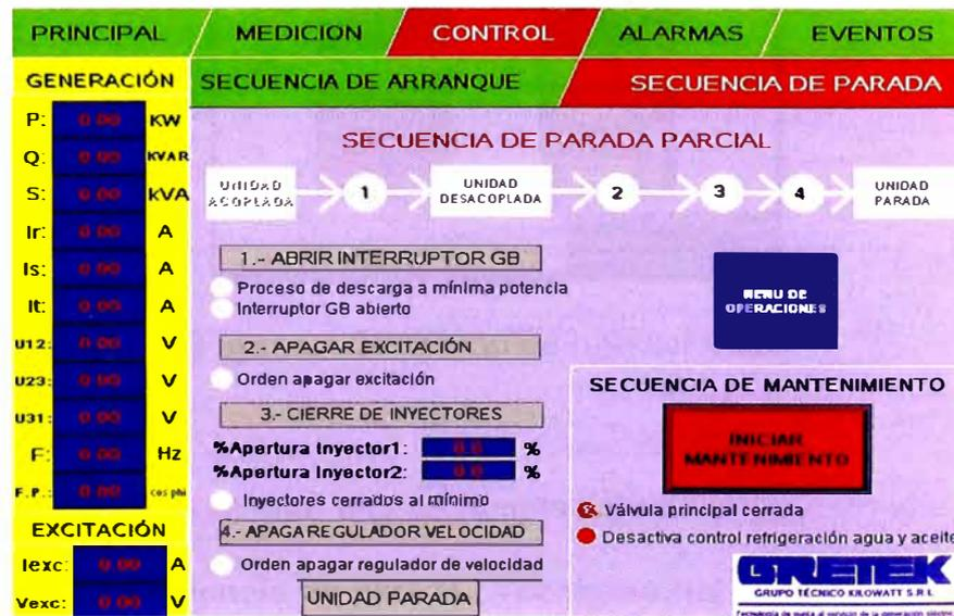
Figura 4.27. Pantalla de secuencia de parada y mantenimiento del grupo generador.
