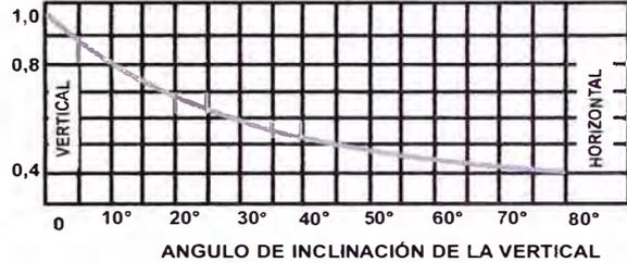
NOTA: PARA TUBERÍAS INCLINADAS QUE TRANSPORTAN FLUJO ASCENDENTE BIFASICO LEA EL FACTOR DE CORRECCIÓN  $f_0$  DE ESTA FIGURA Y MULTIPLIQUE LA VELOCIDAD SUPERFICIAL DEL GAS,  $V_{sg}$ , POR  $f_0$ , ANTES DE INTRODUCIR LOS VALORES EN EL EJE DE LAS ORDENADAS DE LA FIGURA 4, PARA OBTENER LA RELACION  $V_{sl}/V_{sg}$  NO CORRIJA  $V_{sg}$
