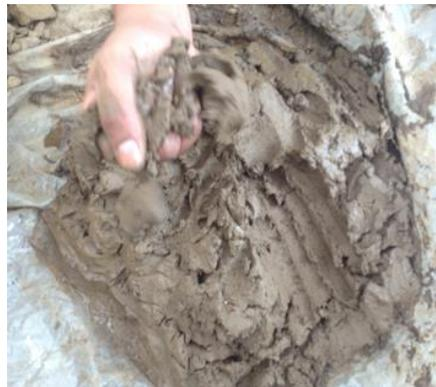
Figura 7. Mezcla de tierra con agua, consistencia plástica.
