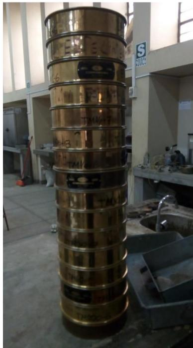
**Figura 5.** Ubicación de tamices de mayor abertura (superior) a menor abertura (inferior) para realizar la separación de partículas por tamizado.
