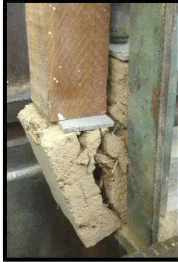
Figura 41. Corte o rotura del adobe, fin de la prueba.
