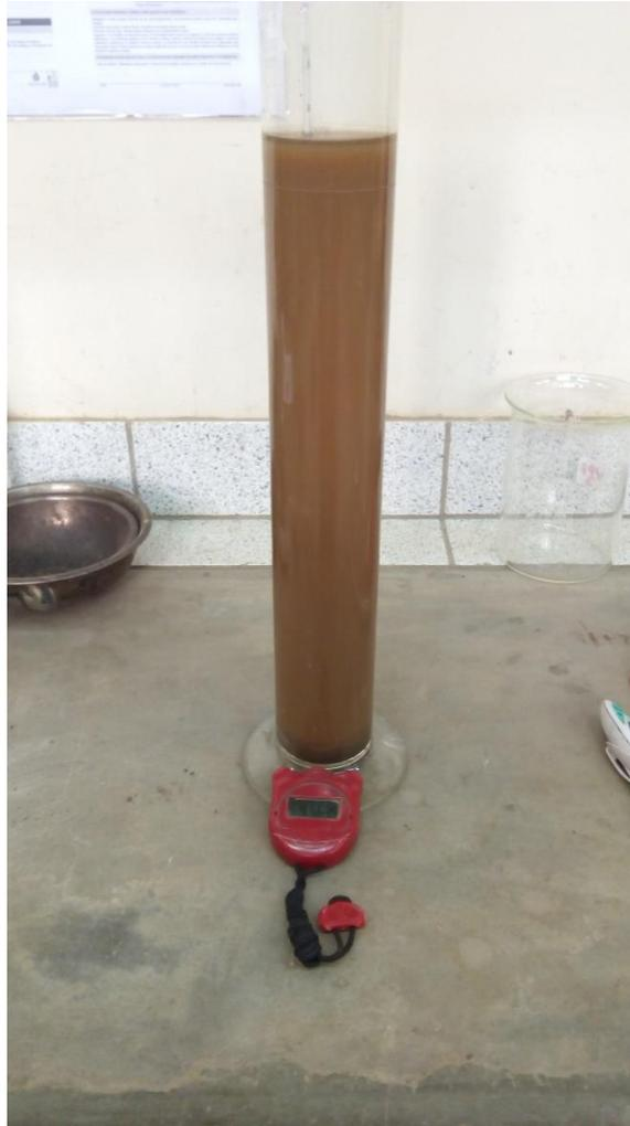
**Figura 6.** Tierra en suspensión para el ensayo de hidrometría.
