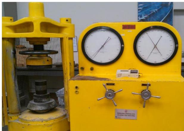
Figura 23. Máquina Uniaxial para compresión, ubicada en el Laboratorio de Ensayo de Materiales de la Facultad de Ingeniería Civil de la UNI.
