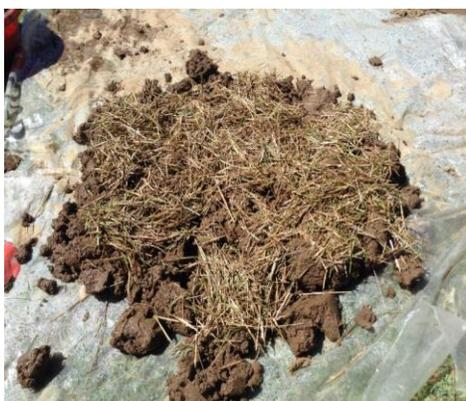
Figura 8. Mezcla de tierra tamizada y dormida con ichu seco.
