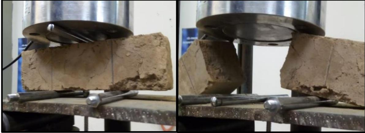
Figura 40. Rotura del ensayo de flexión.
