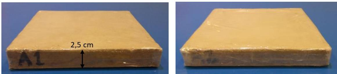
Figura 35. Juego de adobes sin fibra para medición de conductividad térmica.
