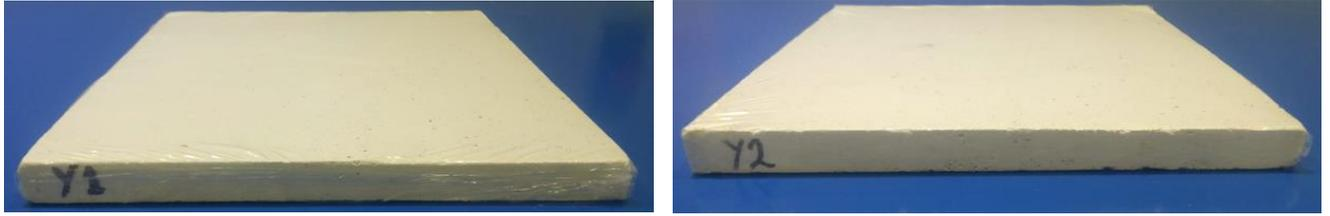
**Figura A12.** Juego de yeso para medición de conductividad térmica
