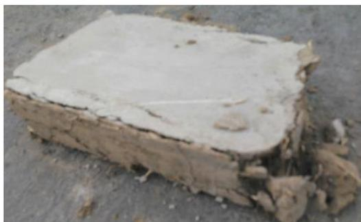
Figura 37. Rotura del adobe después del ensayo a la compresión.
