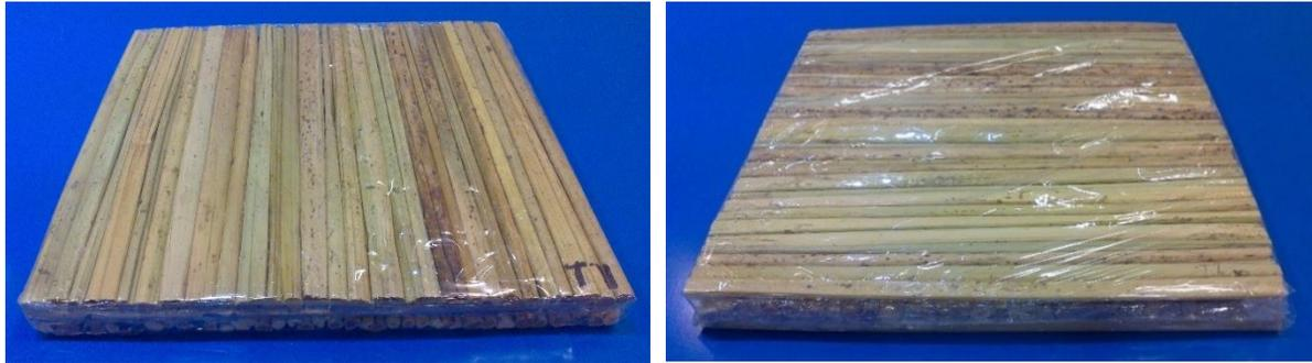
**Figura A13.** Juego de totora para medición de conductividad térmica
