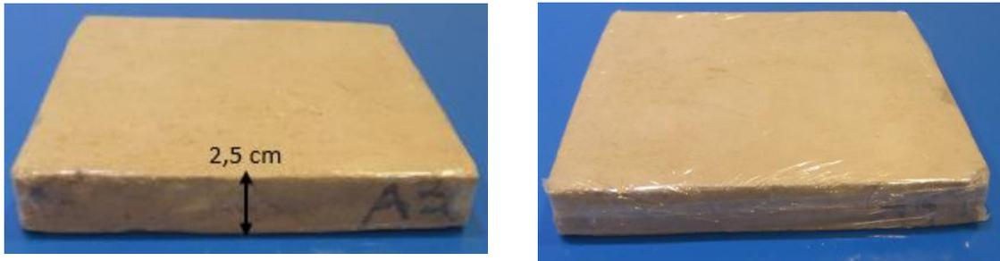
**Figura 34.** Juego de adobes con fibra para medición de conductividad térmica.
