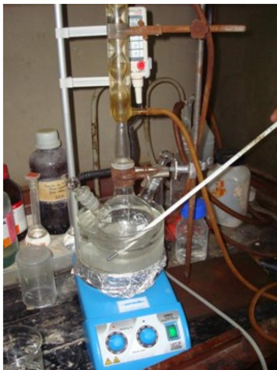
**Figura 4.11.** Preparación del sol de  $ZnO$
