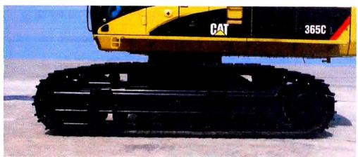
Gráfico 4.25 Tren de rodamiento de la excavadora 365C L
