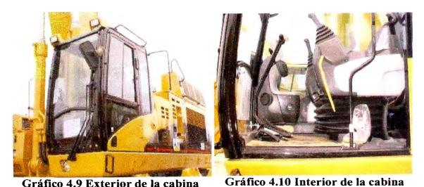
La cabina incluye el Caterpillar Monitoring System (Sistema de Monitoreo Caterpillar), que monitorea constantemente todas las funciones del motor, implementos y traslación. El sistema permite una rápida localización de las fallas, resultando en una elevada disponibilidad y menores tiempos de paradas del equipo.
