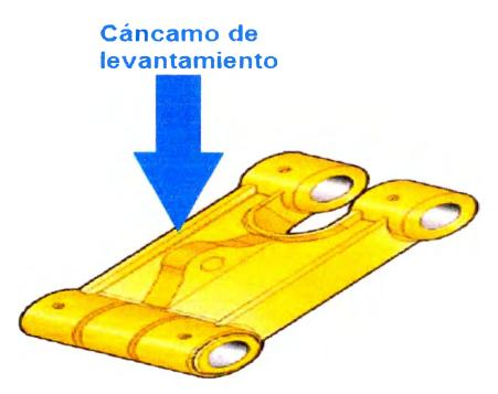
Gráfico 4.28 Eslabón de potencia del varillaje del cucharón
