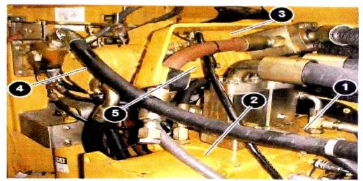
Gráfico 4.23 Bombas del sistema hidráulico
