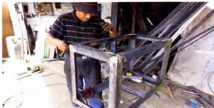
Figura 5.30 Fabricación del coche según plano
