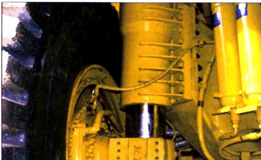
Figura 2.9 Suspensión delantera derecha
