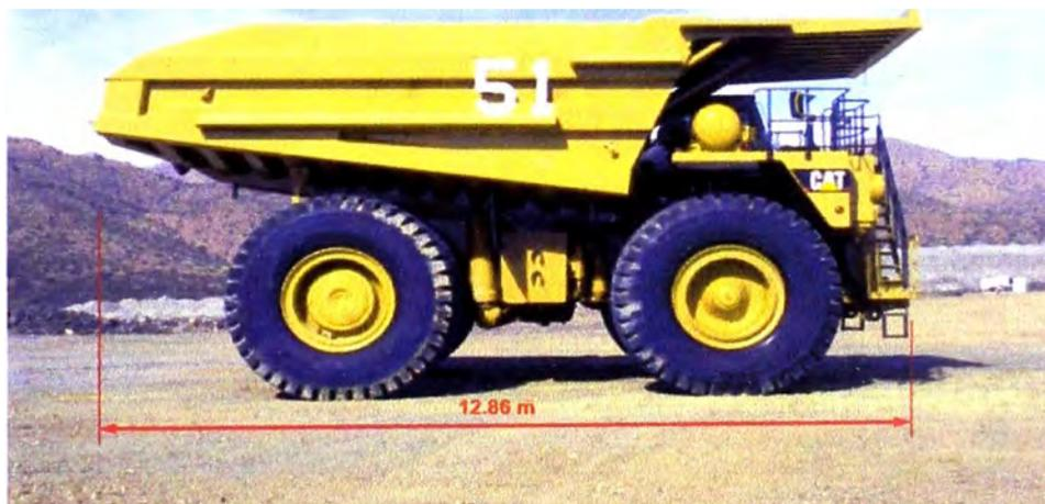
Figura 2.3 Vista del camión de costado
