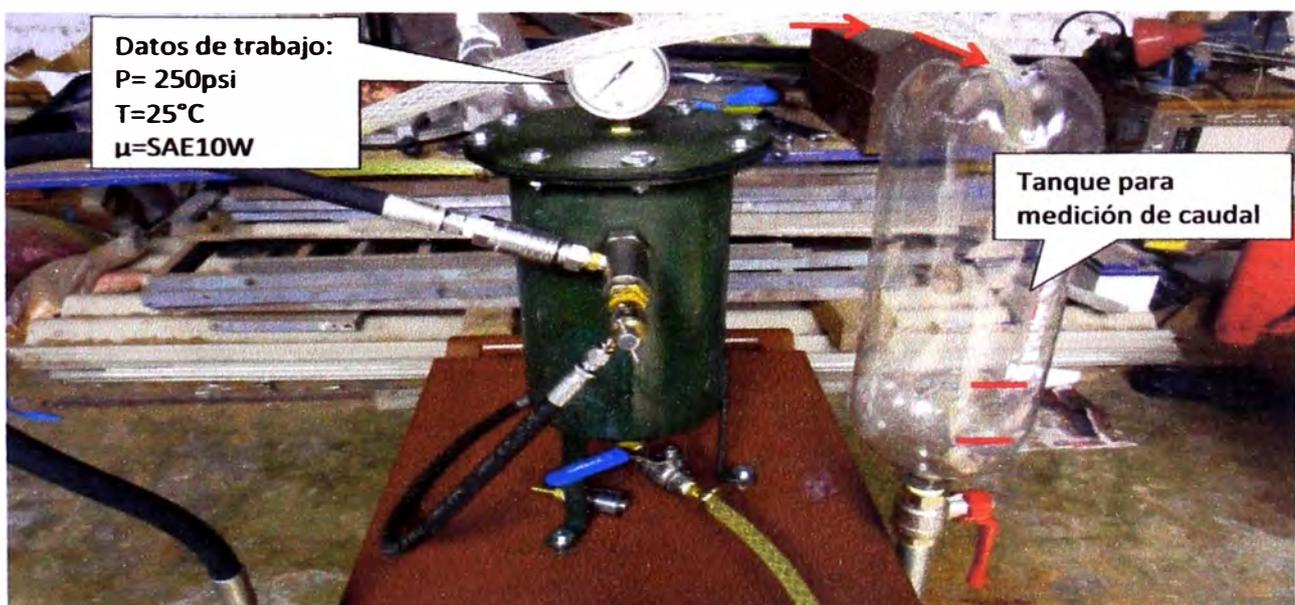
Figura 5.33 Medición del caudal con el banco de pruebas
