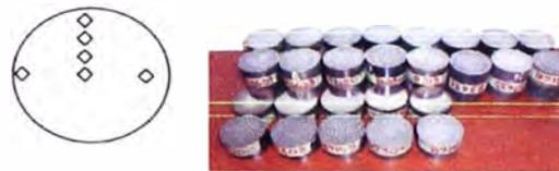
Figura 1 Probetas usadas en el estudio (der) y esquema de las posiciones usadas para la medición de dureza en la cara plana de las probetas (izq).
