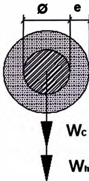
Figura N° 2.6: Conductor con manguito de hielo, afectado solo por el hielo.
