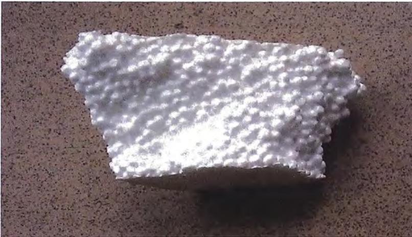
Figura 3.17: POLIESTIRENO GRANULADO Y EXPANDIDO
