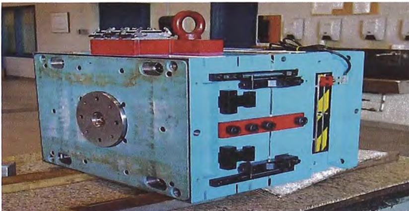
Figura 3.26: MATRIZ TÍPICA CON SISTEMA DE COLADA CALIENTE.
