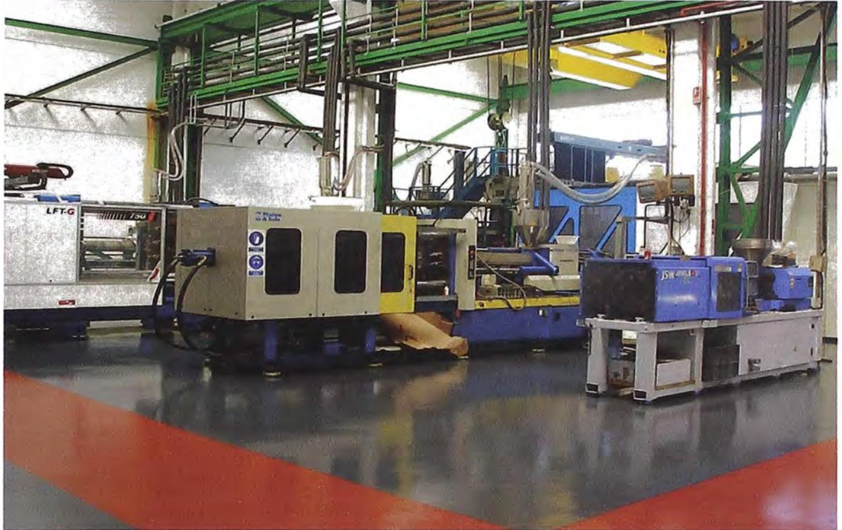
Figura 3.22: MAQUINAS INYECTORAS DE ACCIONAMIENTO HIDRÁULICO
