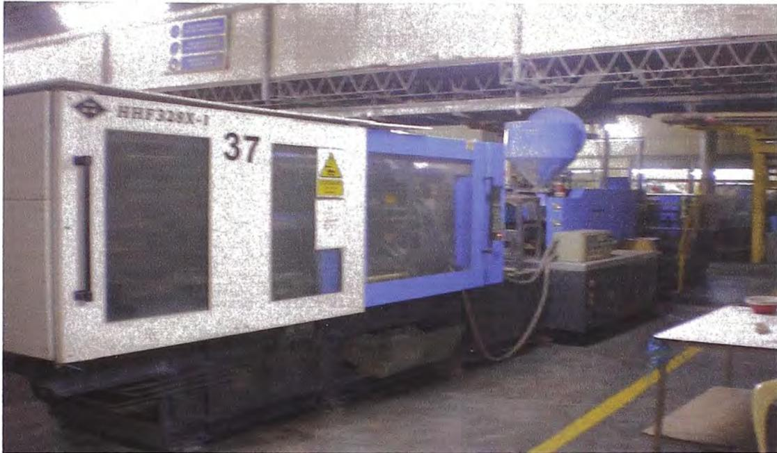
Figura 3.1: MAQUINA INYECTORA DE 320TONELADAS DE PRENSA
