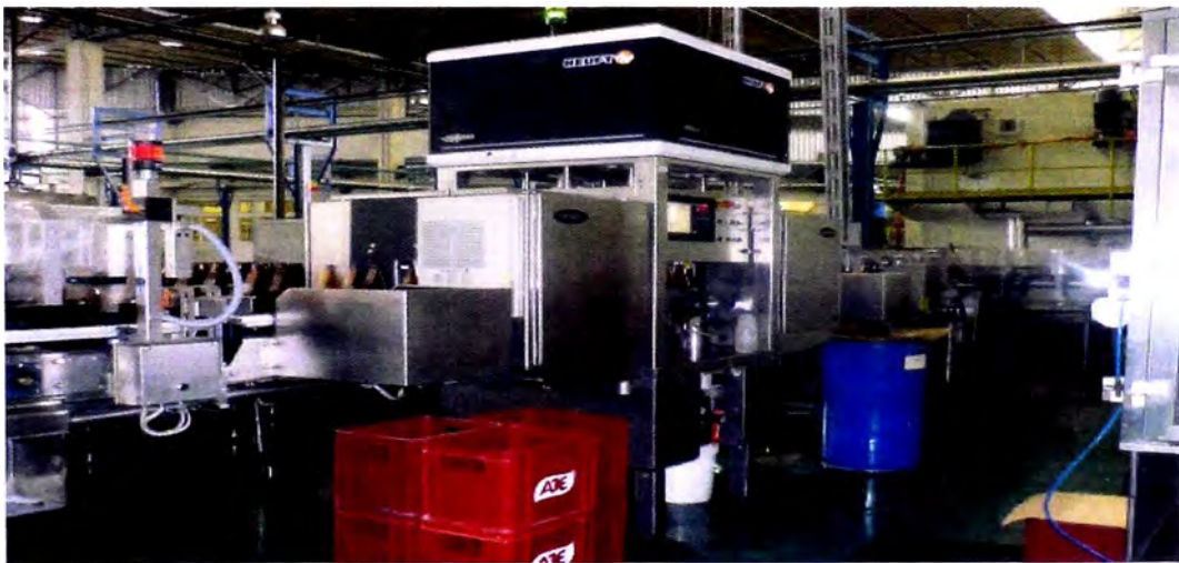
Fig. 3.12 Inspector Botellas Vacías Heuft
