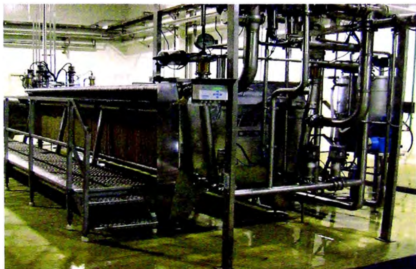
Fig. 3.5 Sección de Filtración
