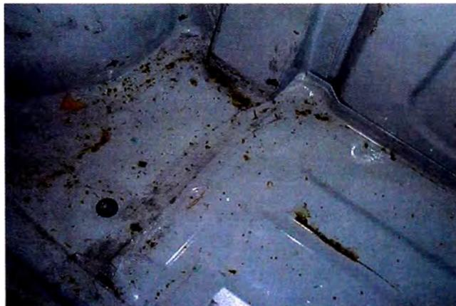
Obsérvese en la figura que la película original está en buen estado y que con una simple limpieza se puede retirar el óxido observado.
