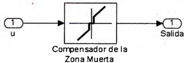
**Figura 4.13:** Diagrama de bloques de la compensación de la zona muerta.
