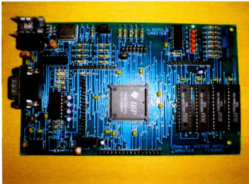
Figura A.13: Tarjeta de Control DSP - TMS320F240.
