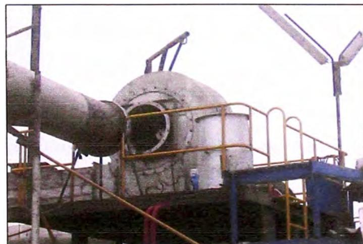
Figura 18 Exhaustor de secadores rotadisk
