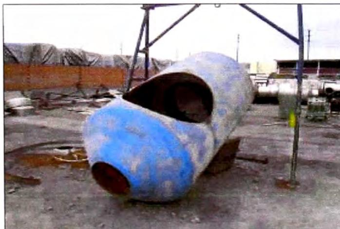
Figura 39 Fabricación de condensador barométrico
