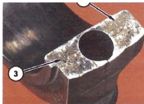
Fig. 4-17. Corrosión por rozamiento en una tapa de biela.
