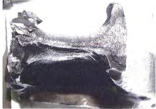
La biela del cilindro N° 3 se encontró con fractura frágil.
