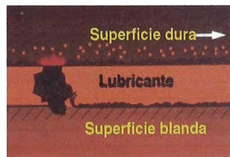
Fig. 4-2. Desgaste abrasivo entre 3 cuerpos.
