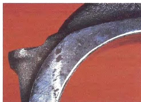
Fig. 4-13. Corrosión en tapa de biela
