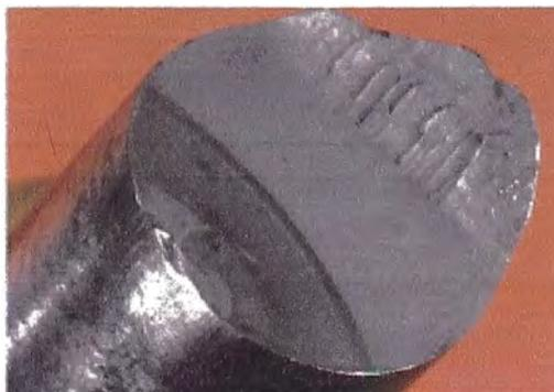
Fig. 4-23. Fractura por fatiga de altos ciclos.
