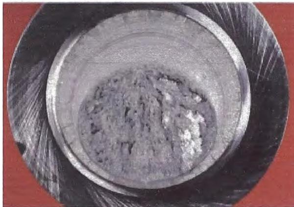
Fig. 4-24. Fractura por fatiga de tracción.
