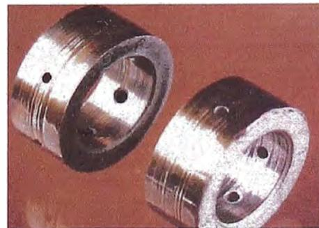
Fig. 4-4. Cojinetes de turbocargador
