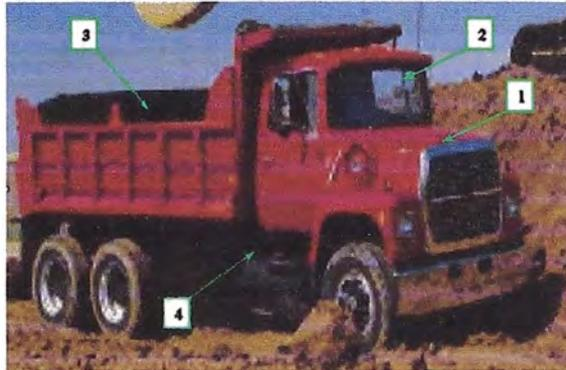
Fig. 2-7. (1) Motor. (2) Cabina del operador. (3) Tolva. (4) Transmisión.
