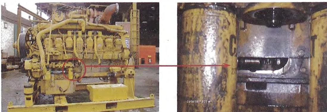
Motor que ingresó al taller con rotura del bloque a la altura de la ventana de inspección del cilindro N° 4.
