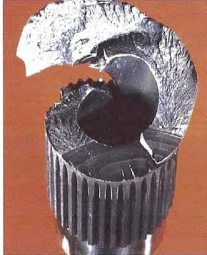
4-22. Fractura por fatiga de bajos ciclos.
