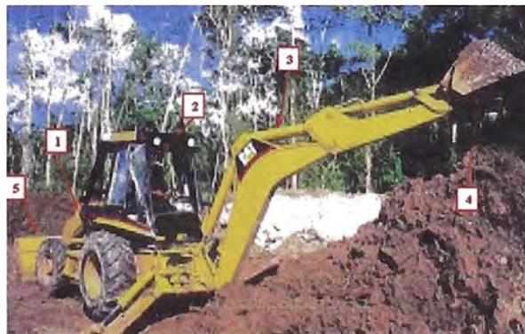
Fig. 2-4. (1) Motor. (2) Cabina del operador. (3) Cilindros hidráulicos. (4) Cucharón de la excavadora. (5) Cucharón del cargador.
