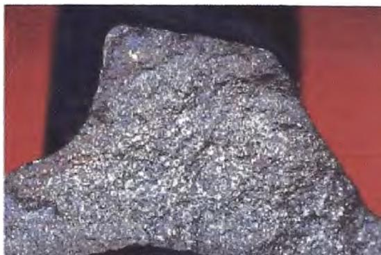
Fig. 4-19. Fractura quebradiza en una pieza de fundición
