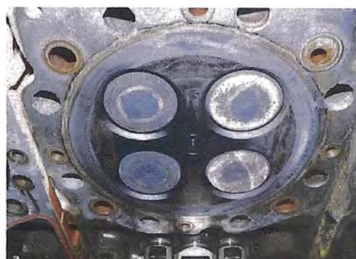
La corona del pistón N° 3 se encontró con marcas de impacto contra las cabezas de las válvulas, las cuales se encontraron flexionadas. Esto indicaría un aumento en el desplazamiento del conjunto pistón-biela.
