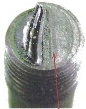
Perno con fractura dúctil por tracción y el otro perno con fractura por fatiga de flexión reversible de bajo ciclo y alta carga (notorias marcas de playa).
