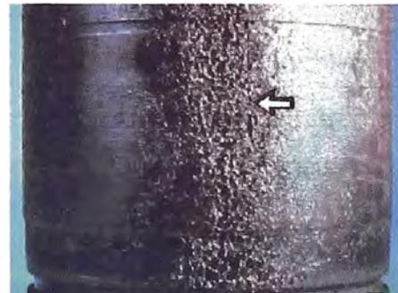
Fig. 4-9. Erosión en la camisa del motor
