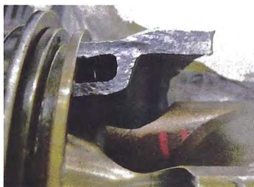
La falda del pistón N° 3 se encontró fracturada y con dos zonas marcadas por desgastes abrasivos (una superior con rayas por desgastes abrasivos y una inferior pulida por rozamiento contra la camisa).
