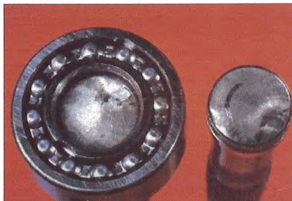
Fig. 4-27. Fractura por fatiga por flexión giratoria.
