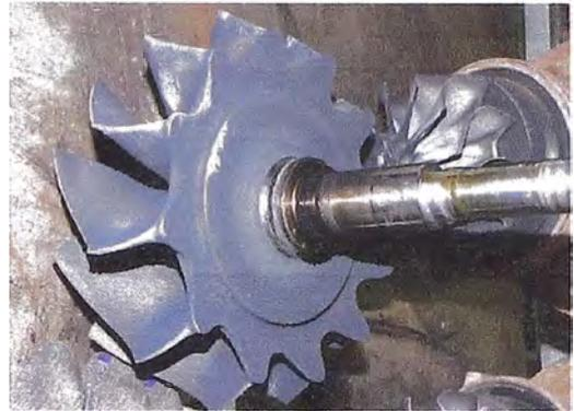
Presentaron desgastes abrasivos no severos. Sin daños en los álabes de la turbina, ni en el del compresor.
