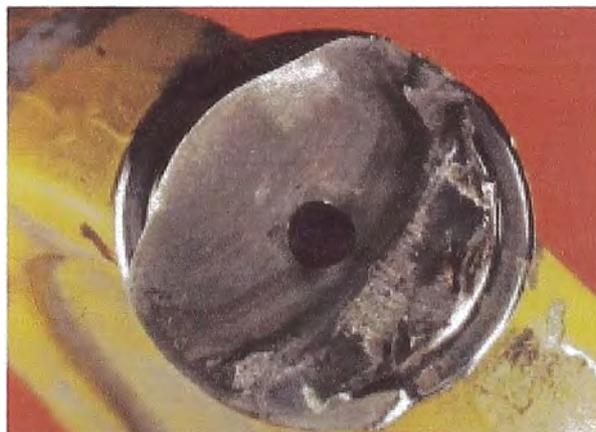
Fig. 4-25. Fractura por fatiga por flexión.
