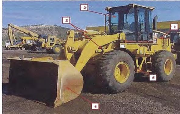
Fig. 2-3. (1) Motor. (2) Cabina del operador. (3) Cilindros hidráulicos. (4) Cucharón. (5) Transmisión
