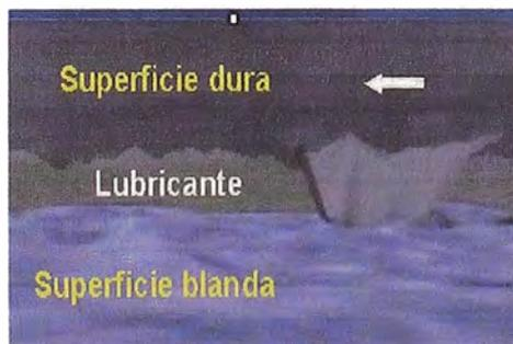
Fig. 4-1. Desgaste abrasivo entre 2 cuerpos.
