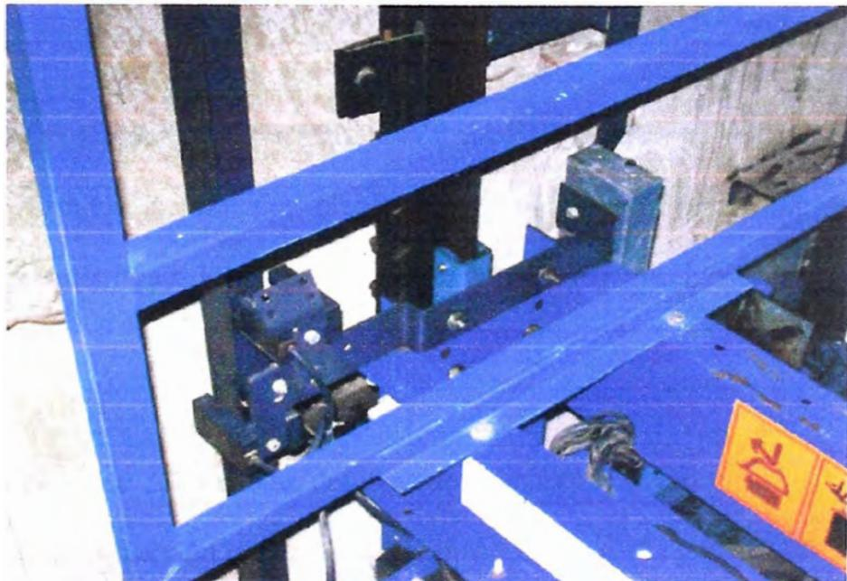
*Dibujo 5.18 Vista de la parte superior de la cabina, se observa los sensores del elevador y el final de carrera de niveles extremos*
