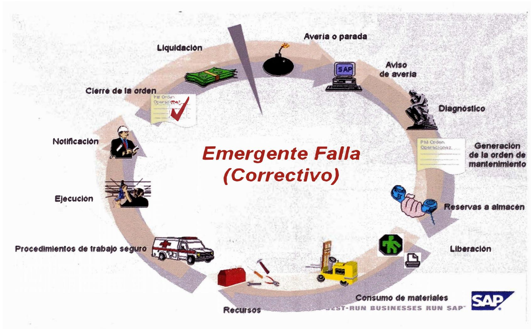
Fig. 4.8 Ciclo de pasos de una falla y su mantenimiento correctivo en el SAP.
